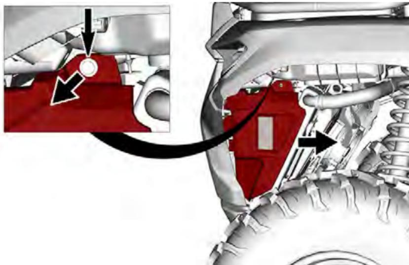
2. Revise el radiador y las mangueras para descartar la presencia de fuga y daños.
