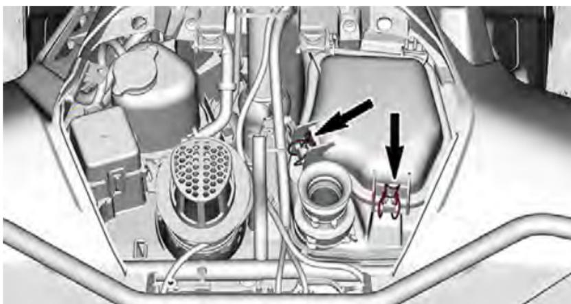
3. Levante la cubierta y tire hacia atrás.
