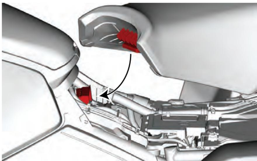
2. Empuje la parte trasera del asiento para colocarlo correctamente.
