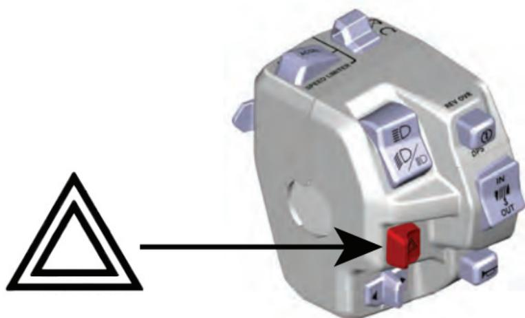
Pulse el botón hacia el lado para encender las luces de emergencia. Púlselo hacia el otro lado para apagarlas.
