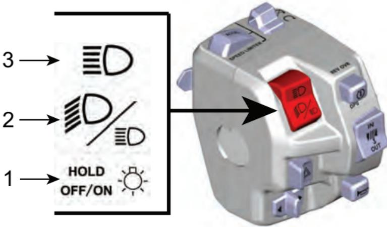
1. Reductor de luz/Faro apagado (OFF)
