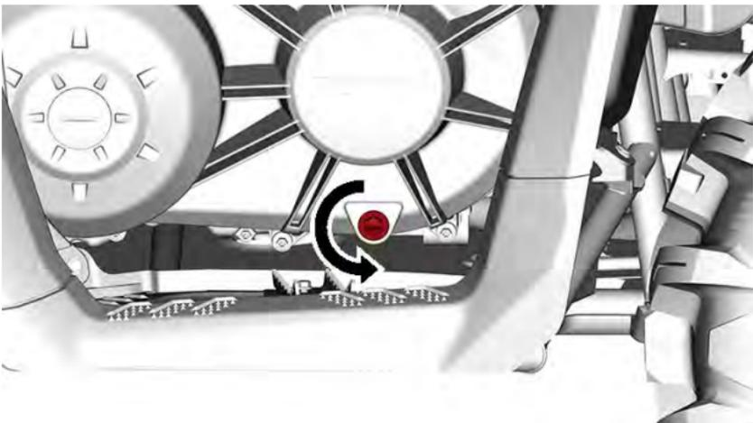
2. Instale de nuevo el tapón de drenaje hexagonal ranurado 15 mm (19/32 pulg).
