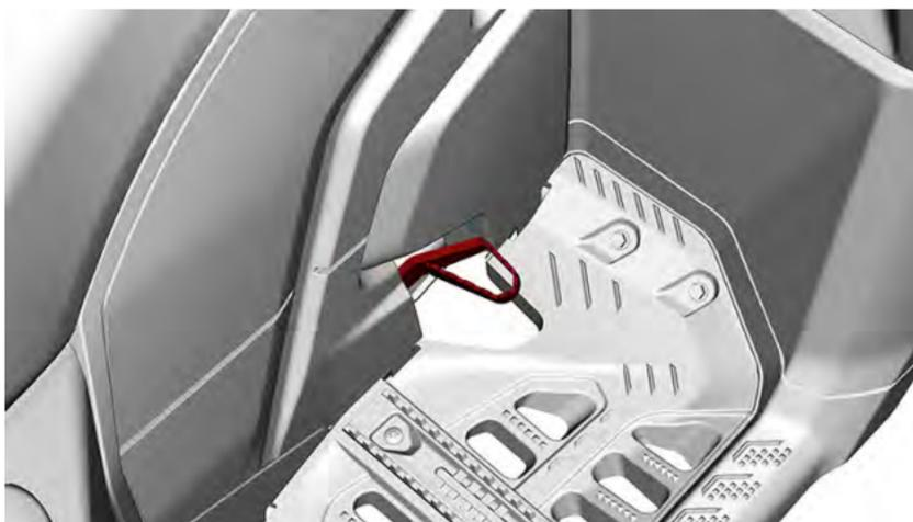
Cuando se presiona el pedal de freno, se acciona el freno trasero.
