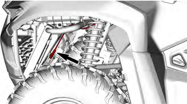
3. Mueva el ventilador del radiador hacia la parte izquierda del vehículo.
