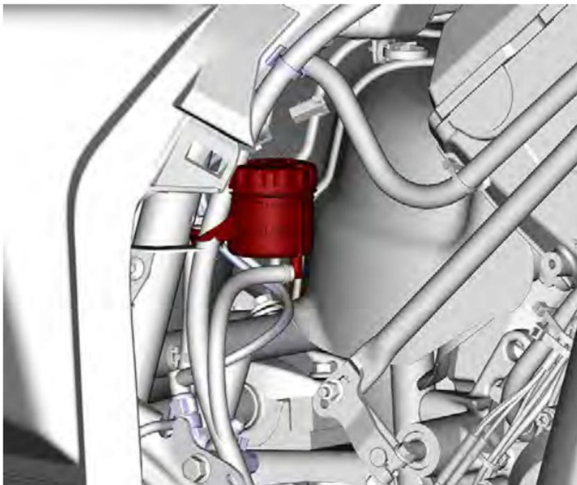
**Comprobación del nivel del depósito del freno trasero (con sistema ABS).**
