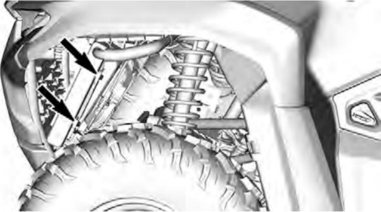
2. Desconecte el conector del ventilador del radiador.
