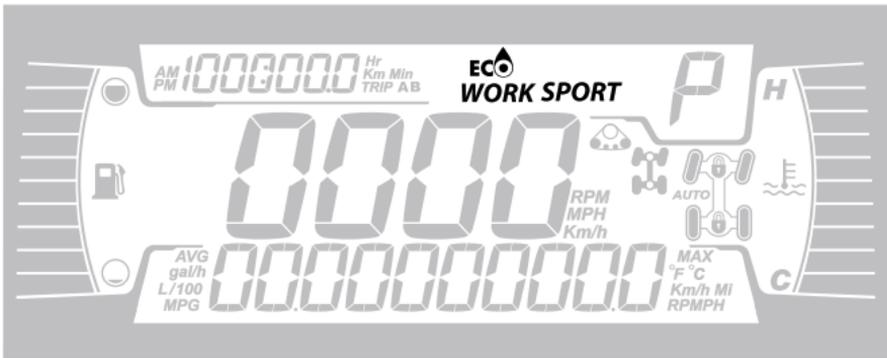
La pantalla para modo del motor indica el tipo de operación seleccionado:
