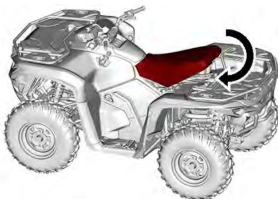
4. Compruebe que el asiento está seguro mediante un tirón, y halando de la parte delantera para confirmar que se ha bloqueado correctamente.
