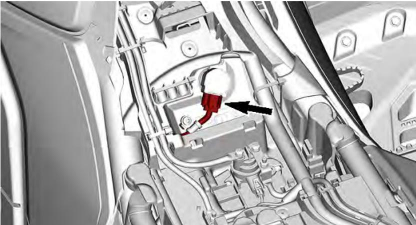
3. Extraiga la bobina de encendido.
