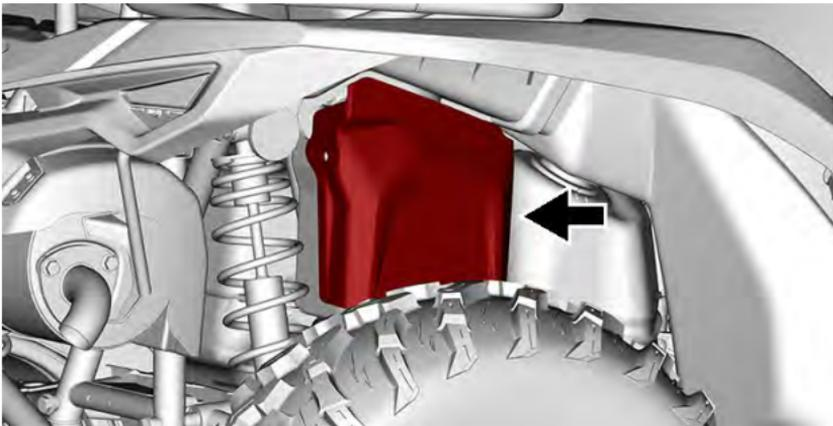
6. Asegure la cubierta de la batería con los remaches de plástico que quitó anteriormente.
