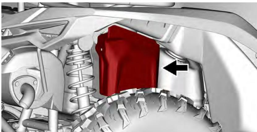
6. Den Batteriedeckel mit den zuvor entfernten Kunststoffnieten sichern.
