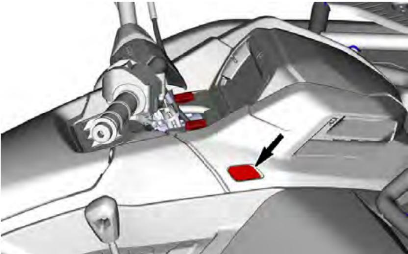
4. Sichern Sie die Konsole durch zwei (2) Vierteldrehungen.
