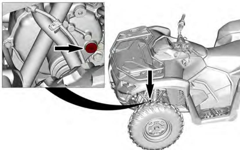
3. Entfernen Sie den Einfüllstopfen.
