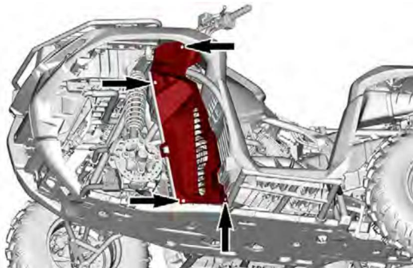
3. Entfernen Sie die linke vordere Fußstütze.
