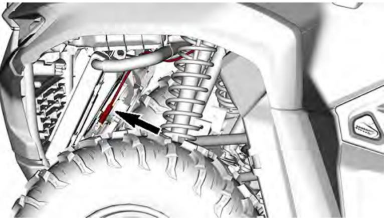
3. Ziehen Sie den Kühlerlüfter zur linken Seite des Fahrzeugs.
