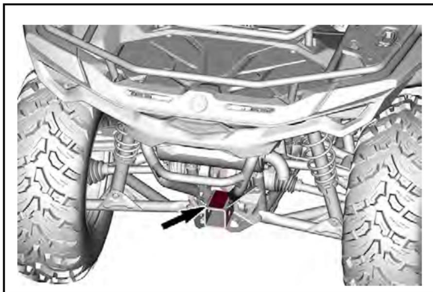
**Warnschild - Ziehen einer Fracht und heiße Oberfläche (hintere Stoßstange)**
