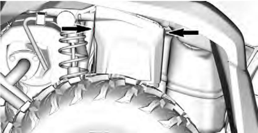
2. Entfernen Sie die Batterieabdeckung.
