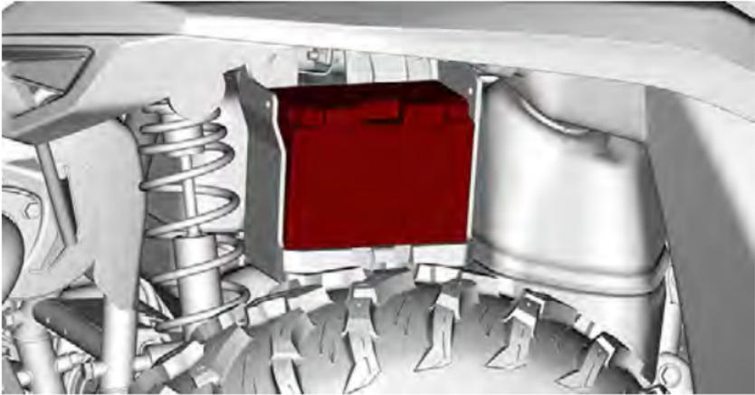
2. Die Batterie mit dem Halteriemensichern.
