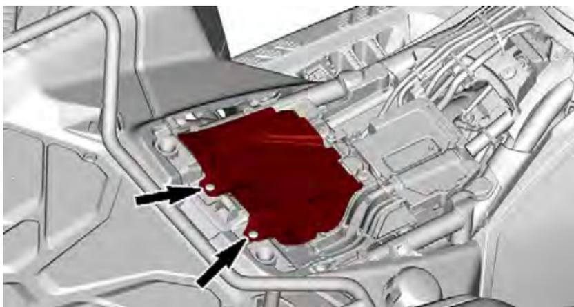
4. Trennen Sie die Kabelbinder, die den Filter an der Halterung sichern.
