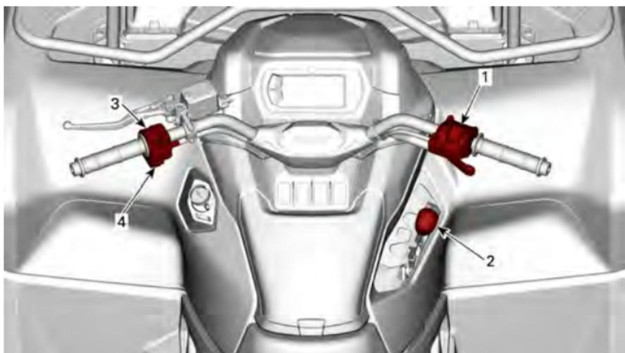
1. *Alloggiamento del comando della leva dell'acceleratore*
