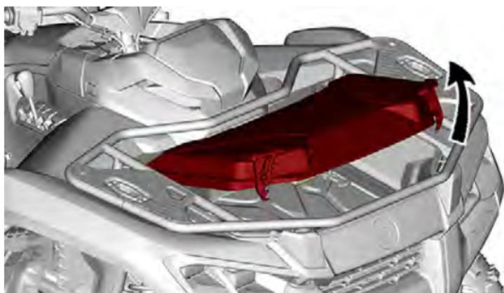
2. Ruotare la leva che si trova all'interno del vano di carico per bloccare la copertura in posizione aperta.
