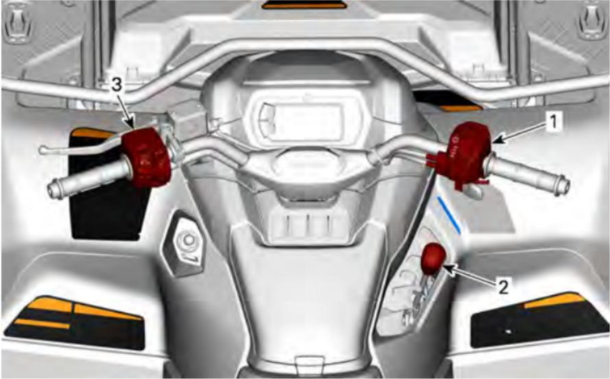
1. Alloggiamento del comando della leva dell'acceleratore
