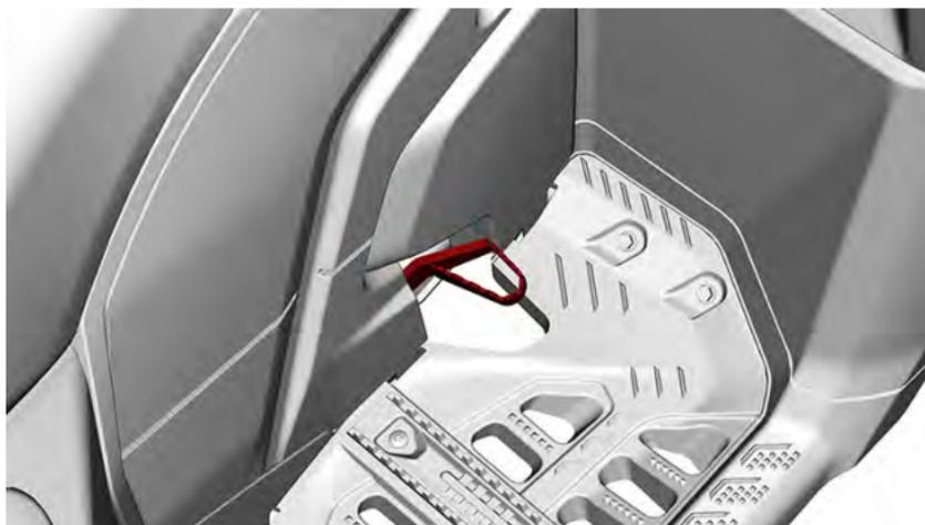
Premendo questo pedale si aziona il freno posteriore.
