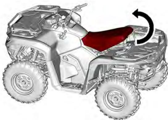
3. Continuare a tirare fino a sganciare il dispositivo di fissaggio anteriore, quindi rimuovere il sedile.
