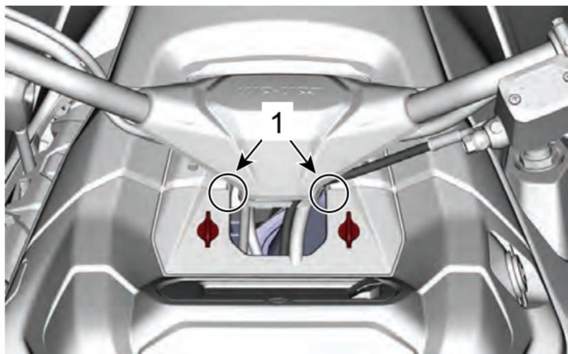
1. Posizione della linguetta di bloccaggio
