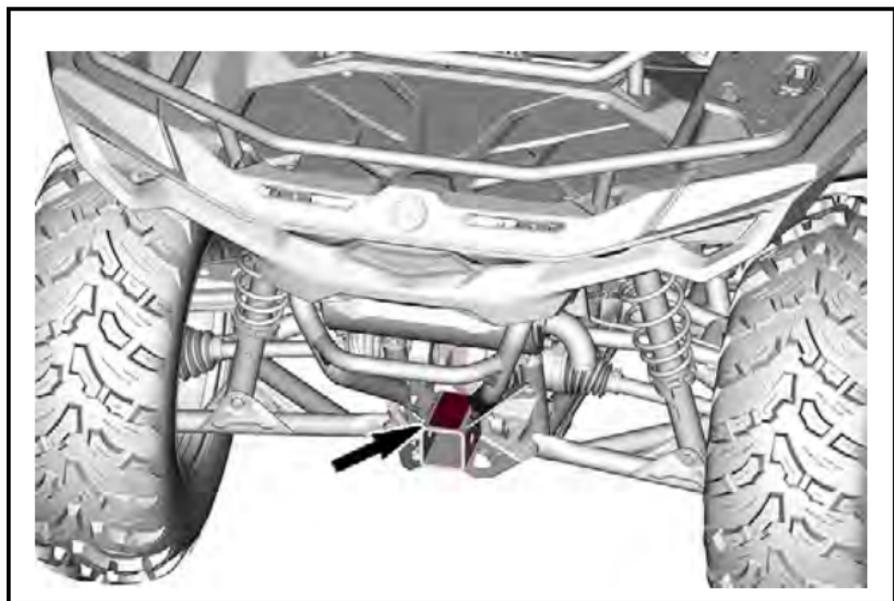
**Tirare un carico e una superficie calda (paraurti posteriore) — Etichetta di avvertenza**
