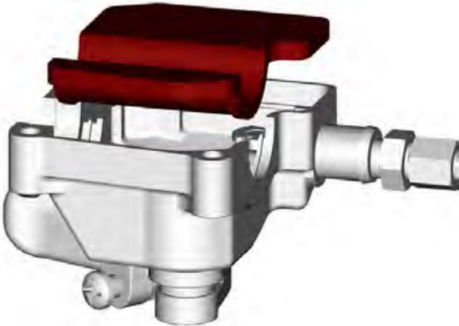
6. Rimuovere il cavo dall'alloggiamento della leva dell'acceleratore facendo scivolare il cavo attraverso la scanalatura del fermo e rimuovendo il terminale del cavo dal fermo.
