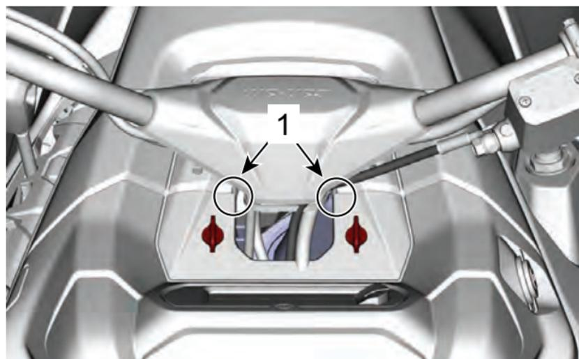
1. Posizione della linguetta di bloccaggio
