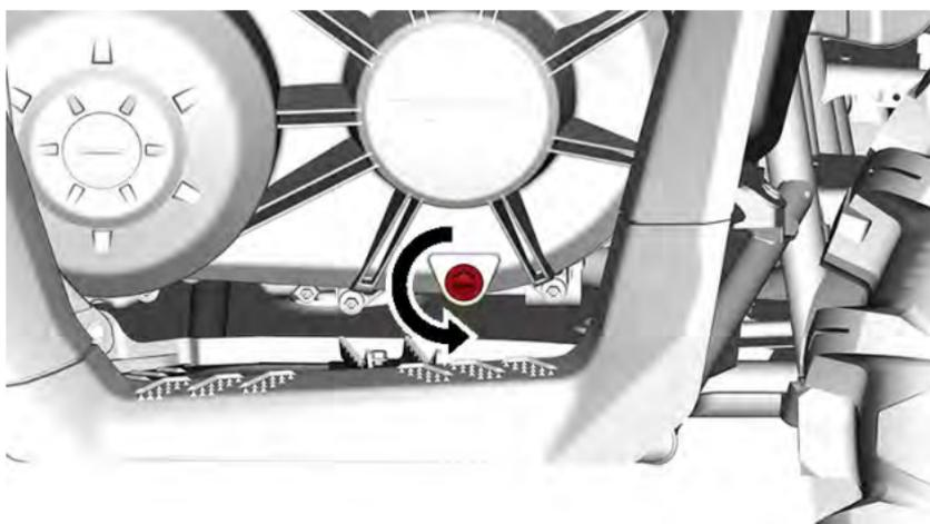
2. Installare nuovamente il tappo di scarico esagonale scanalato 15 mm (19/32 in).
