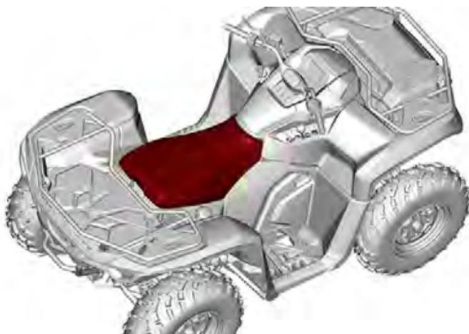
2. Rimuovere le viti del pannello di accesso alla pompa del carburante.
