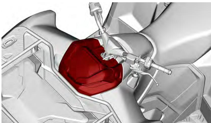
3. Controllare il livello del refrigerante, il livello del liquido dovrebbe essere compreso tra le tacche di MIN e MAX del serbatoio.
