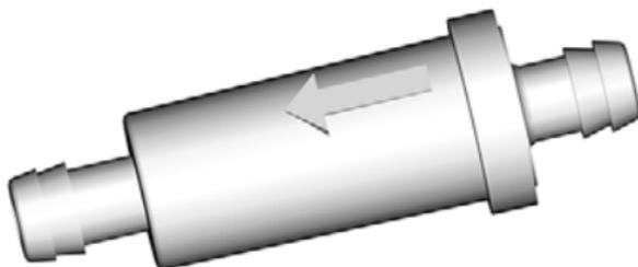
4. Verificare che il filtro sia completamente inserito e il tubo flessibile fissato correttamente.
