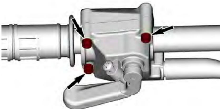
2. Separare l'alloggiamento della leva dell'acceleratore.
