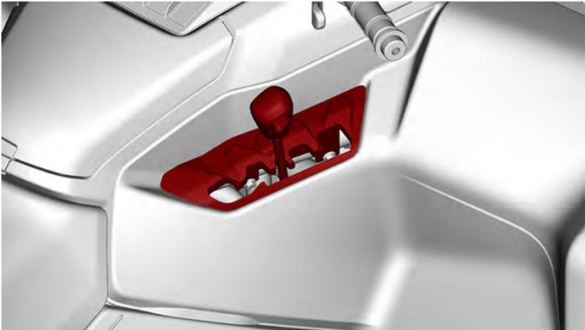
La leva del cambio è utilizzata per cambiare la posizione della scatola del cambio.
