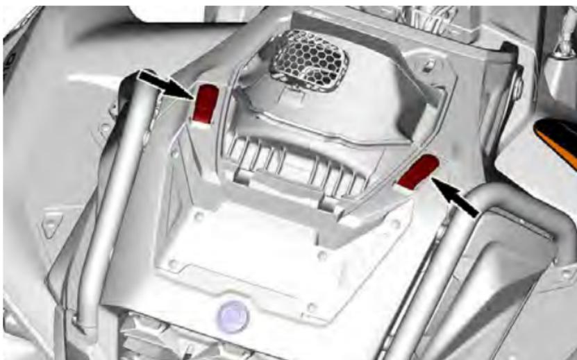
3. Entfernen Sie die vordere Haube, indem Sie sie kippen und anheben.
