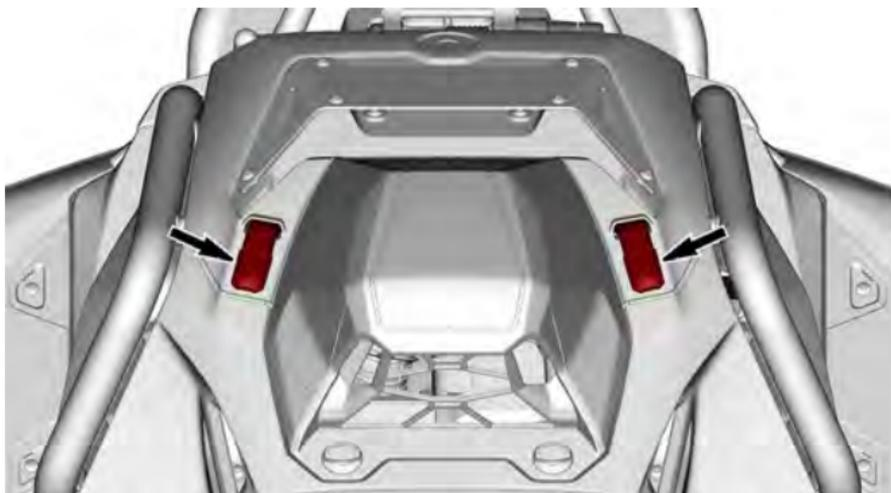
5. Sichern Sie den Schnorchel mit den Vierteldrehschrauben, indem Sie sie im Uhrzeigersinn drehen.
