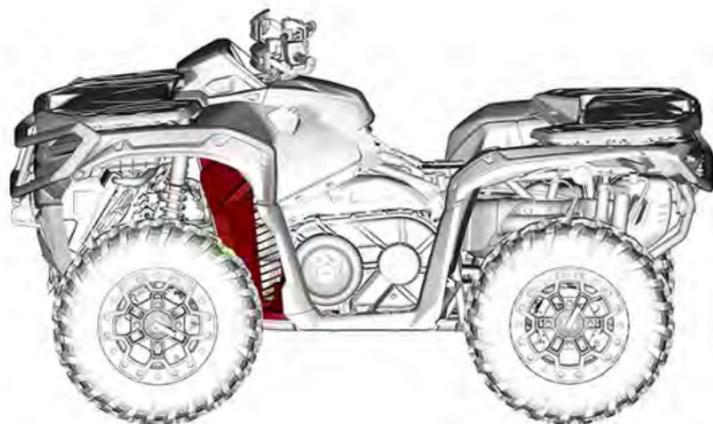
3. Entfernen Sie die linke vordere Fußstütze.
