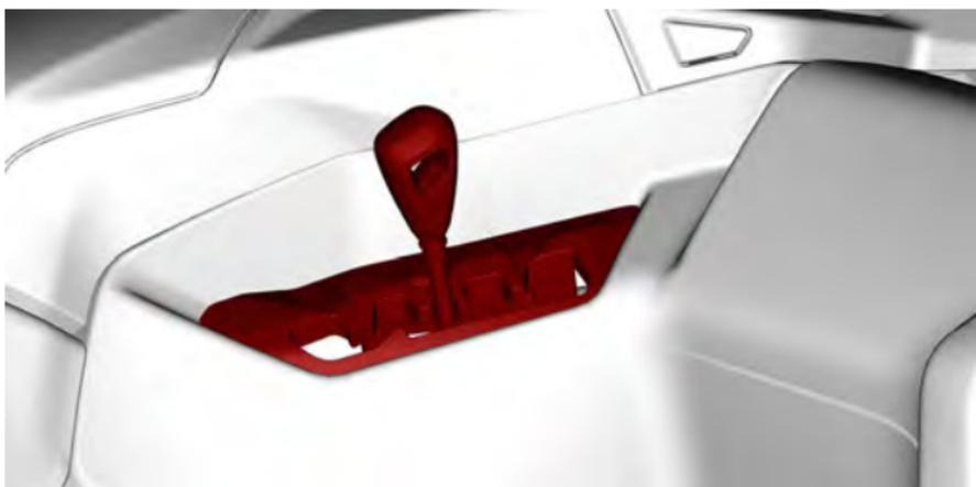
Mit dem Schalthebel wird die Getriebestellung verändert.
