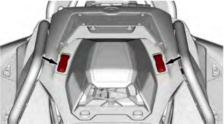
4. Lösen Sie beide Vierteldrehschrauben an der Konsole.
