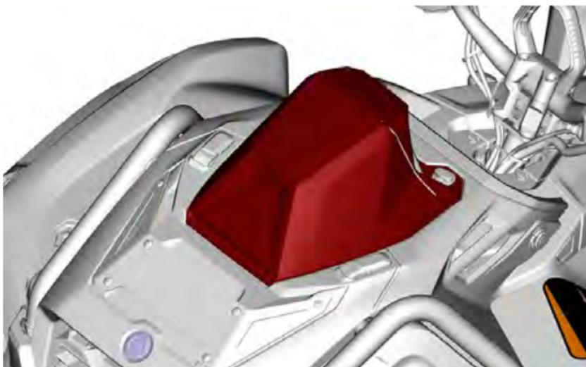
2. Sbloccare entrambi i fermi di fissaggio del cofano anteriore.
