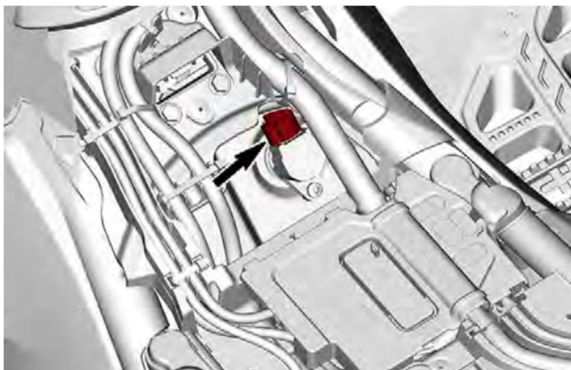
5. Rimuovere la vite di fissaggio della bobina di accensione.
