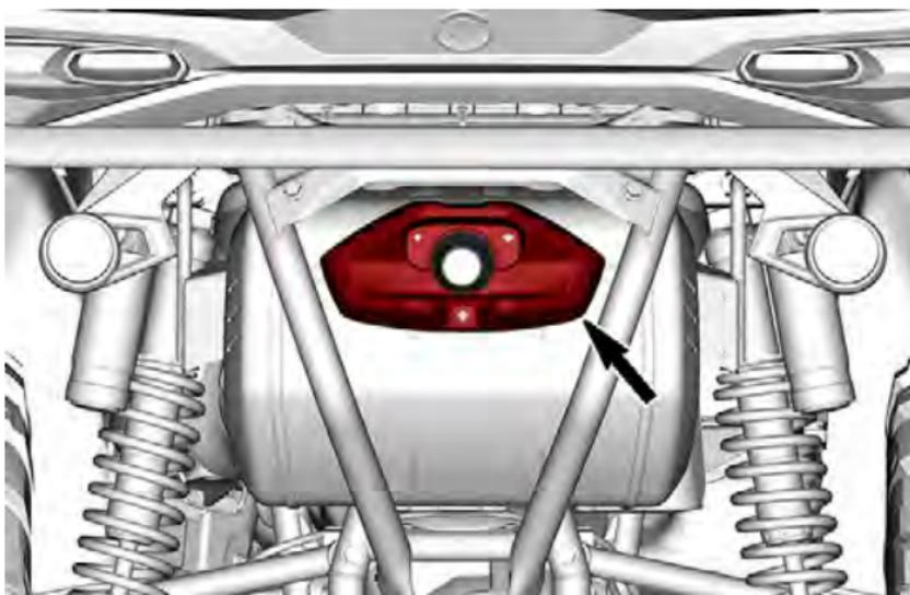
10. Fissare la modanatura dello scarico utilizzando nuove viti. Serrare come da specifiche.
