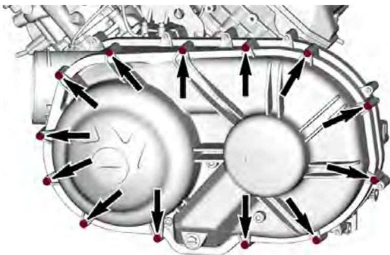
**Suggerimento:** Togliere fine la vite centrale superiore che sostiene la carenatura durante la rimozione.
