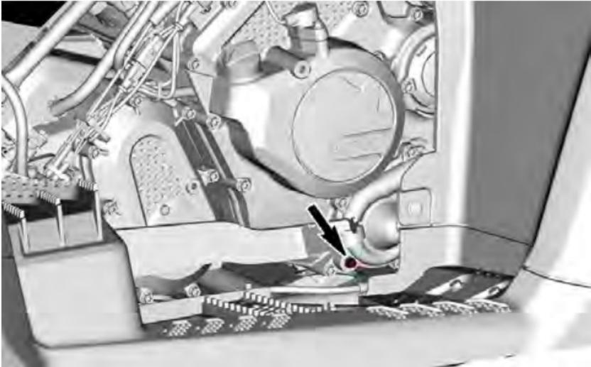
3. Per completare il totale svuotamento del sistema di raffreddamento, scollegare il flessibile del radiatore inferiore dal coperchio della pompa dell'acqua e scaricare il refrigerante rimasto in un apposito contenitore. Smaltire la fascetta Oetiker.
