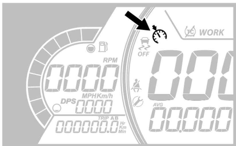
L'attivazione della modalità Limitatore della velocità limita esclusivamente la velocità massima disponibile quando si preme la leva dell'acceleratore.
