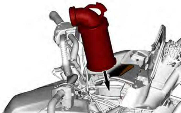
3. Utilizzando l'impugnatura, spingere con forza l'adattatore del filtro dell'aria nella cavità dell'alloggiamento del filtro dell'aria.
