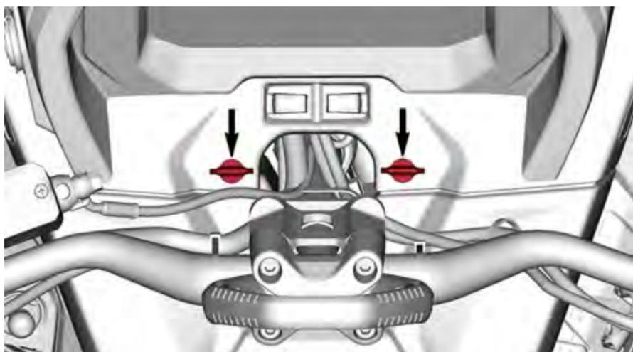
4. Fissare il cofano anteriore con entrambe le cinghie di fissaggio.
