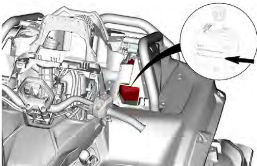
Per aggiungere liquido refrigerante nel sistema, rimuovere il tappo del serbatoio liquido refrigerante.
