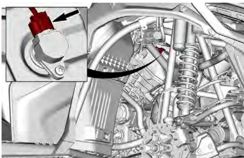
9. Rimuovere la vite di fissaggio della bobina di accensione.
