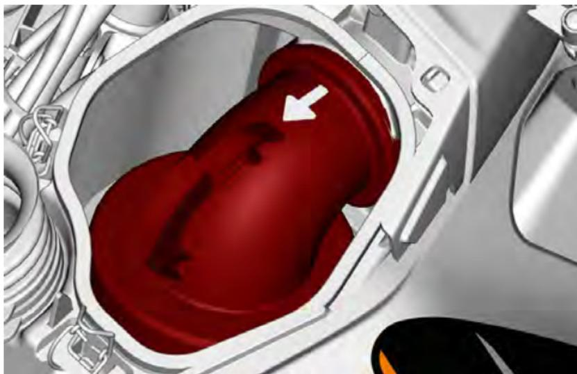
6. Estrarre con cautela l'adattatore del filtro dell'aria e il filtro dell'aria dalla scatola del filtro dell'aria.
