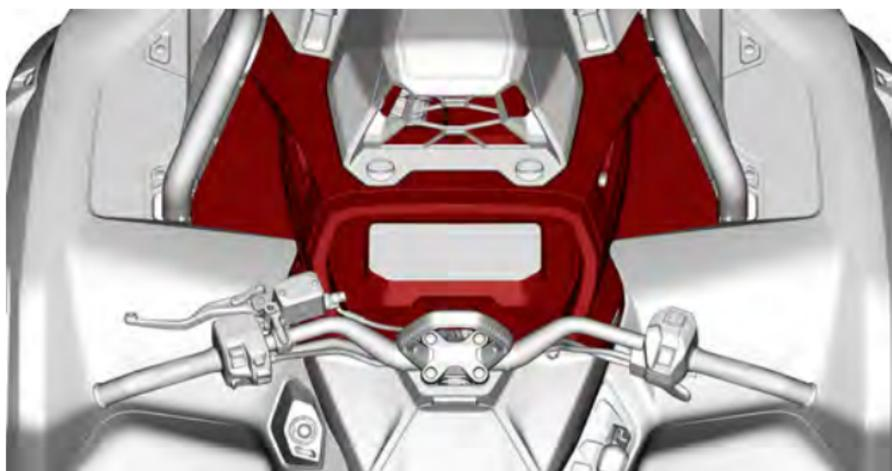
2. Se il veicolo si trova su una superficie piana, il livello del liquido dovrebbe essere compreso tra le tacche di MIN e MAX del serbatoio liquido refrigerante.
