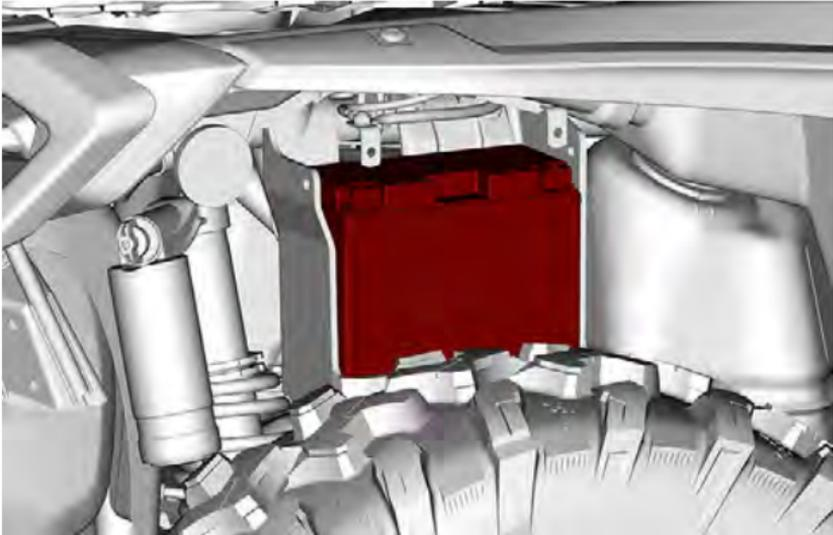
2. Fissare la batteria con la cinghia di attacco della batteria.
