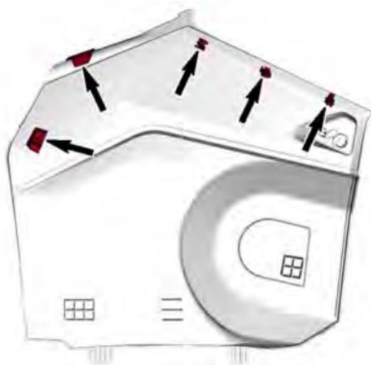
3. Bloccare il pannello laterale ruotando il fermo di bloccaggio.
