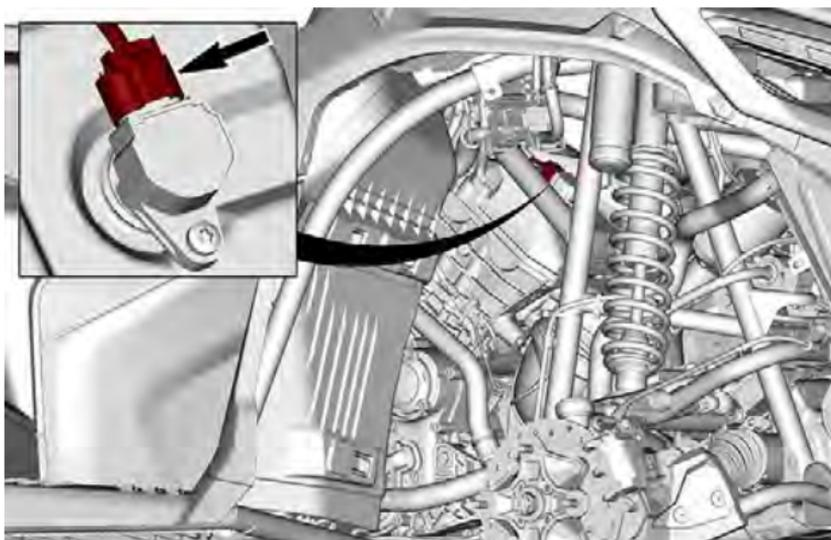
6. Installare la vite morsetto del filo bobina.
