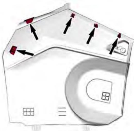
4. Inclinare il pannello laterale verso l'esterno del veicolo e tirare verso l'alto per rimuoverlo dal veicolo.
