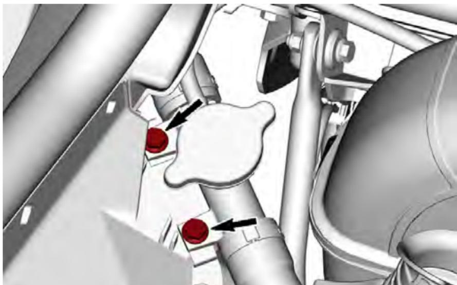
3. Rimuovere la vite di fissaggio del serbatoio del liquido refrigerante al supporto.
