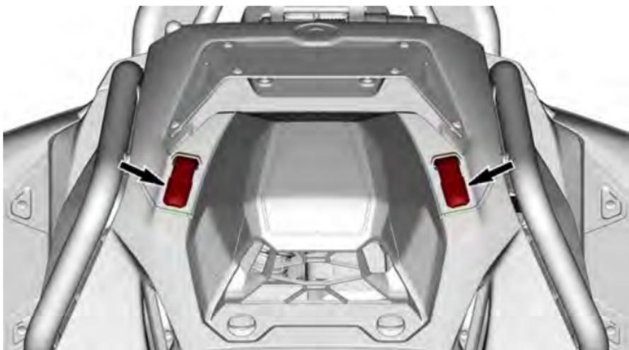
5. Fixe o snorkel com os parafusos de um quarto de volta girando-os no sentido horário.
