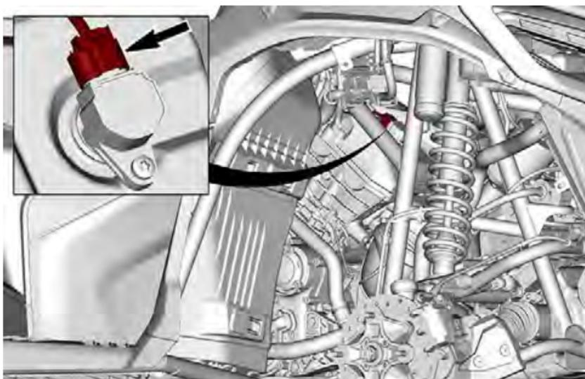
6. Instale o parafuso da braçadeira do fio da bobina.
