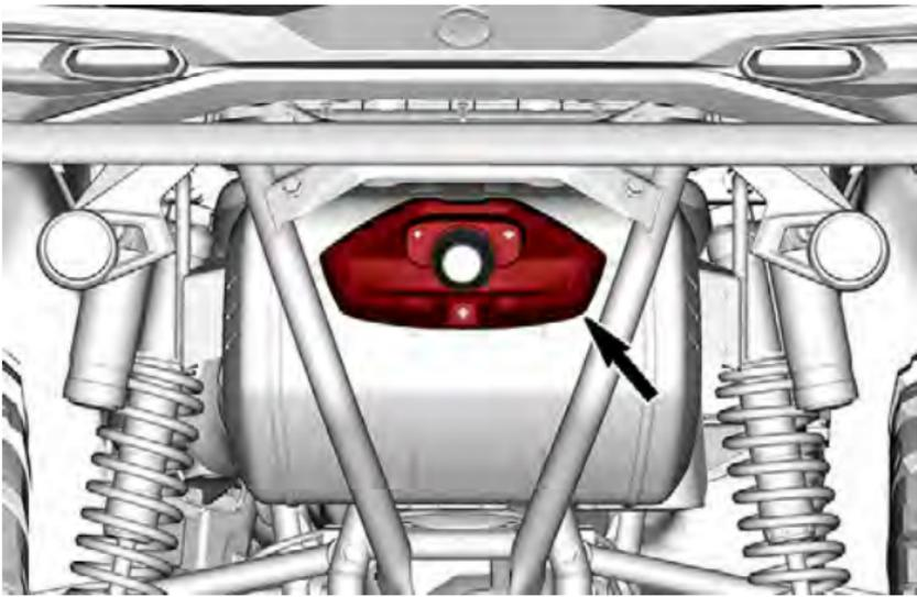
10. Prenda a guarnição do escapamento usando parafusos novos. Aperte de acordo com as especificações.
