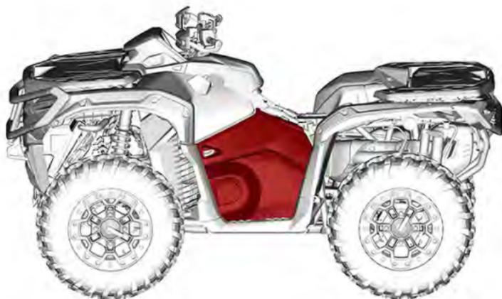
2. Remova o para-lama interno dianteiro esquerdo.
