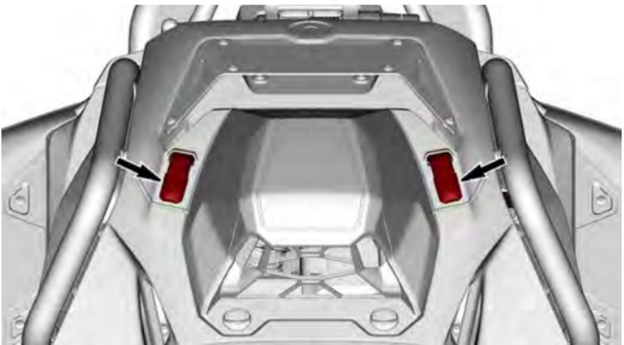
4. Desengate os dois parafusos de um quarto de volta no console.
