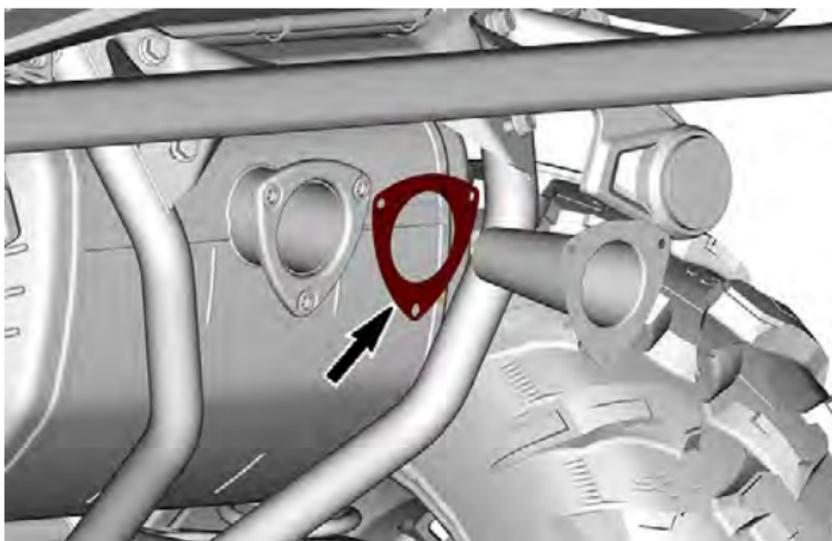
9. Instale a guarnição do escapamento.
