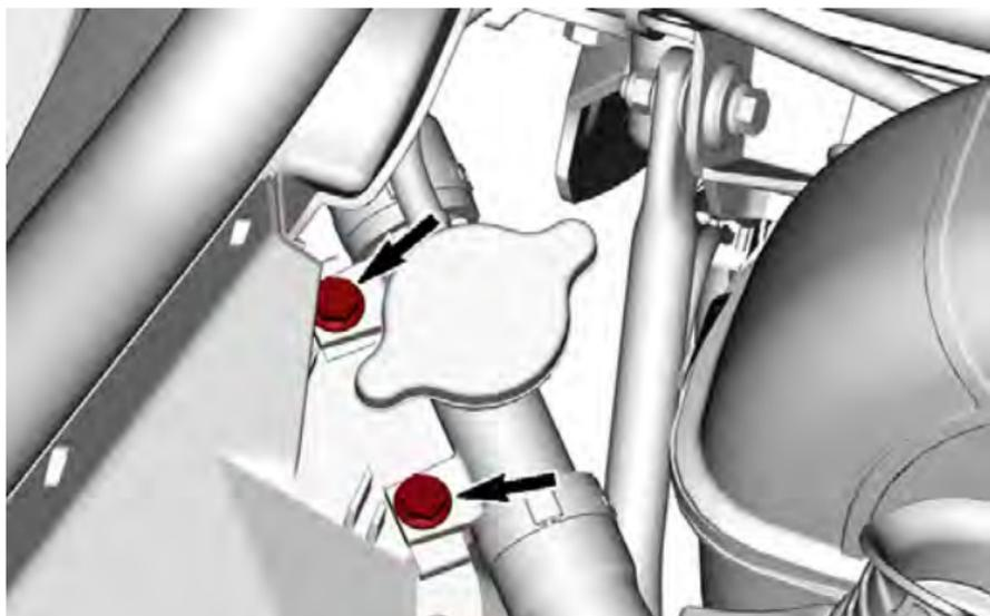
3. Remova o parafuso que fixa o reservatório do líquido de arrefecimento para o suporte.
