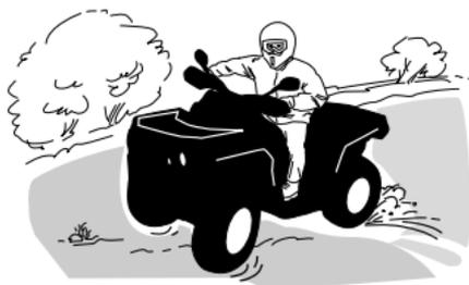
Se você deslizar ou derrapar, virar o guidão na direção do movimento pode ajudar a recuperar o controle do veículo. Nunca freie com força e trave as rodas.
