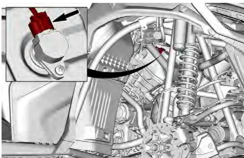
9. Remova o parafuso de retenção da bobina de ignição.
