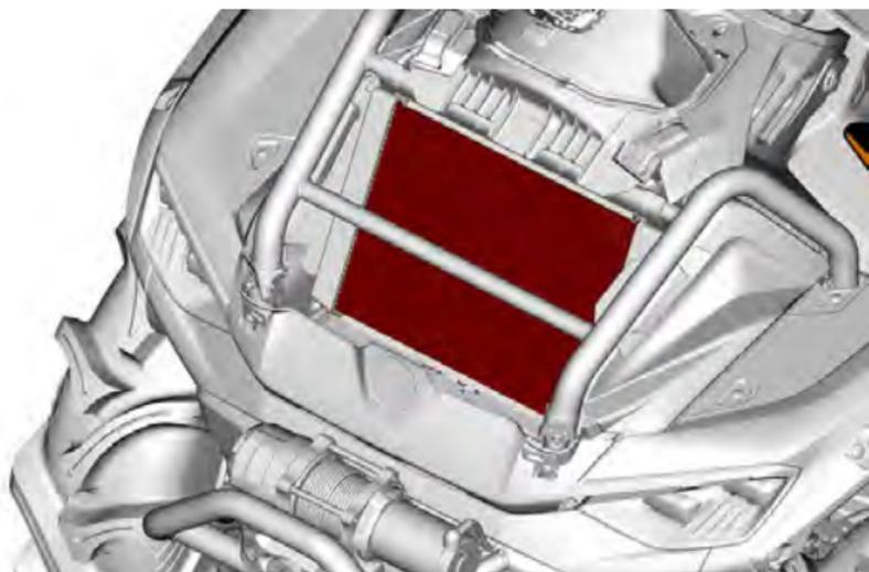
5. Inspeção o radiador e as mangueiras quanto a vazamentos e danos.
