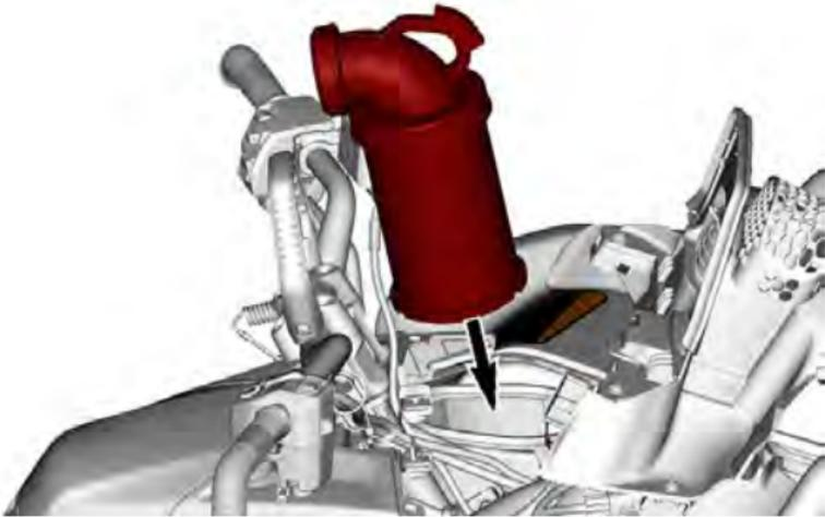
3. Usando o apoio, empurre o adaptador de filtro de ar para a cavidade da carcaça do filtro de ar.
