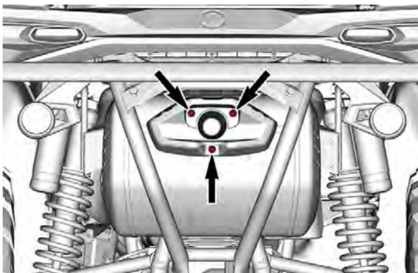
2. Remova a guarnição do escapamento.
