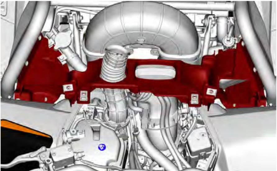
1. Remova os parafusos de retenção de cada lado do suporte.
