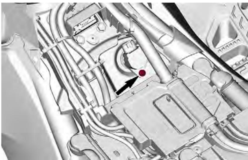
6. Retire a bobina de ignição.
