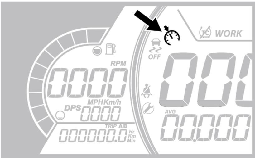
Ativar o modo de operador do limitador de velocidade somente limita a velocidade máxima disponível ao pressionar o acelerador.
