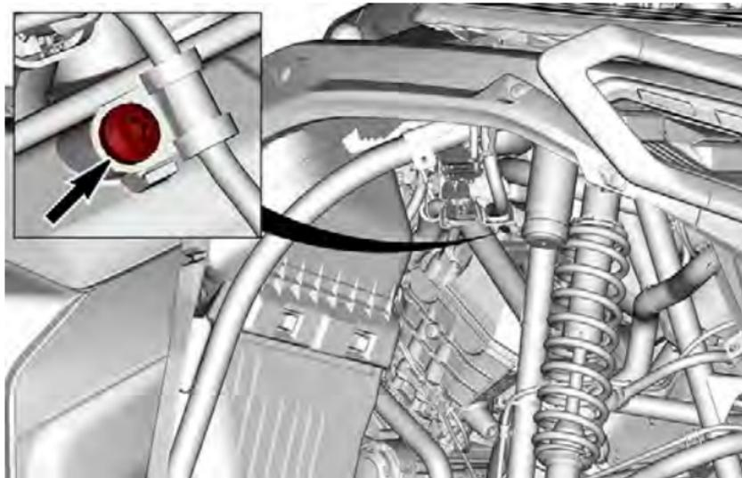
8. Desligue o conector da bobina de ignição.
