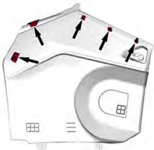
4. Incline o painel lateral exterior do veículo e puxe para cima para removê-lo do veículo.
