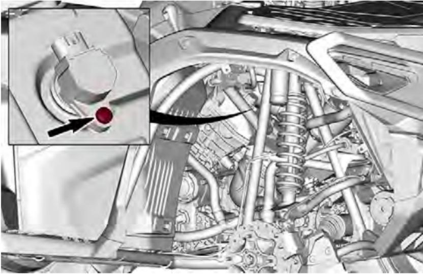
10. Retire a bobina de ignição.
