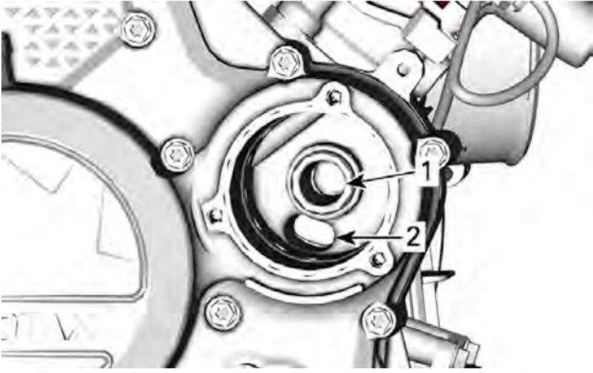
1. Furo de saída para o sistema de alimentação de óleo do motor
