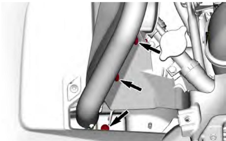
2. Remova ambos os parafusos retendo o bocal de abastecimento.
