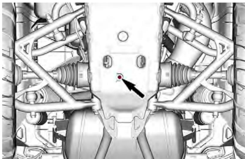
4. Stellen Sie eine Ablaufwanne unter das Hinterachsgetriebe.
