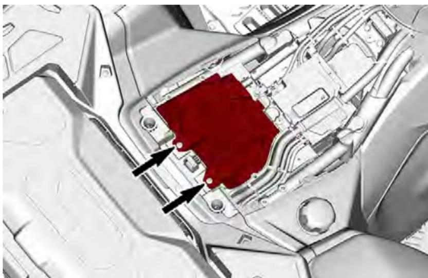
4. Trennen Sie die Kabelbinder, die den Filter an der Halterung sichern.
