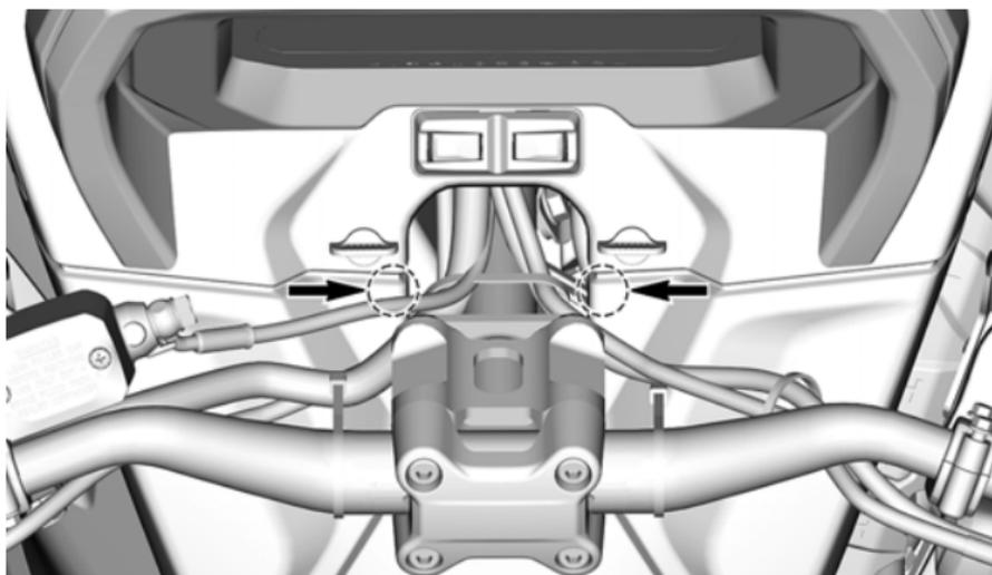
3. Stellen Sie sicher, dass der Knopf an beiden Seiten in der Konsole eingerastet ist.
