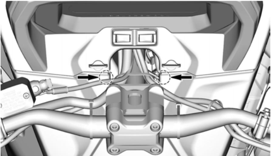
4. Um die Konsole zu entfernen, ziehen Sie sie nach oben.
