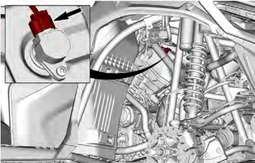
6. Montieren Sie die Schraube der Zündspulenklemme.
