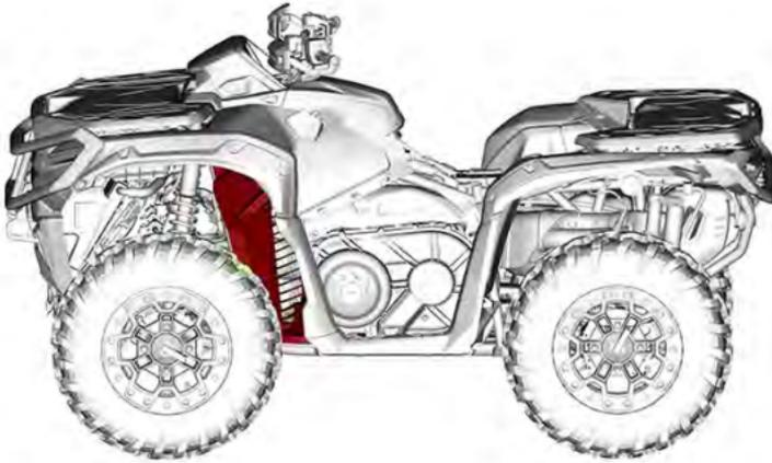
3. Entfernen Sie die linke vordere Fußstütze.
