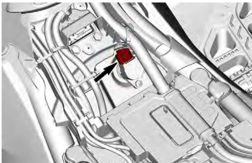
5. Entfernen Sie die Befestigungsschraube der Zündspule.
