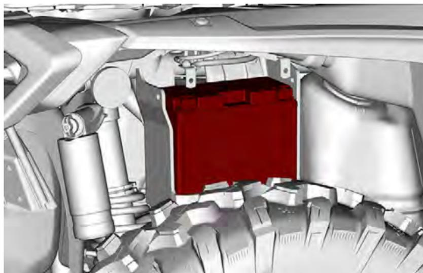
2. Die Batterie mit dem Halteriemen sichern.
