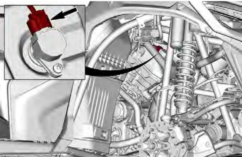
7. Entfernen Sie die Befestigungsschraube der Zündspule.
