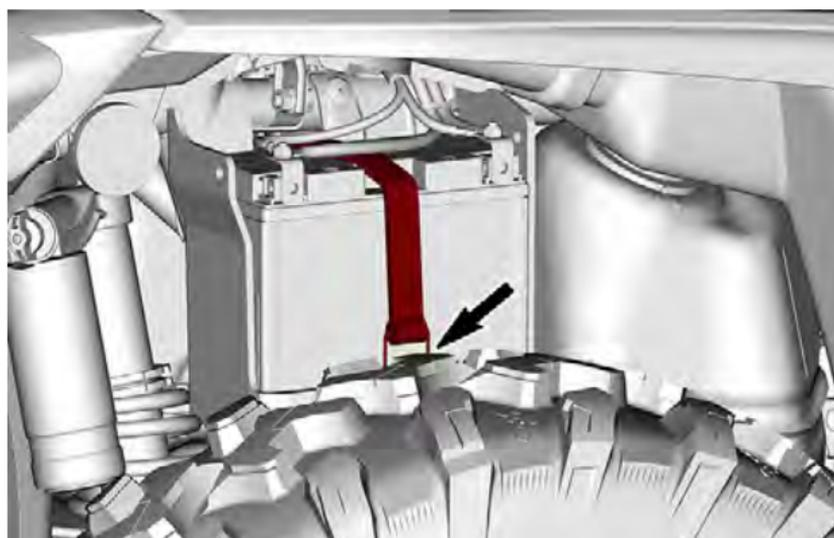
3. Zuerst das ROTE Batteriekabel (+), danach das SCHWARZE Batteriekabel (-) anschließen.
