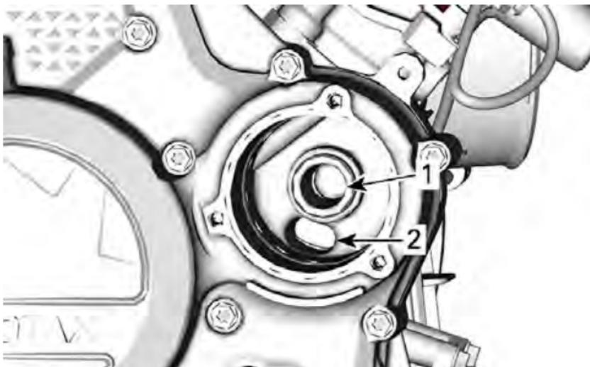
1. *Auslass-Bohrung zur Ölspeisung des Motors*
