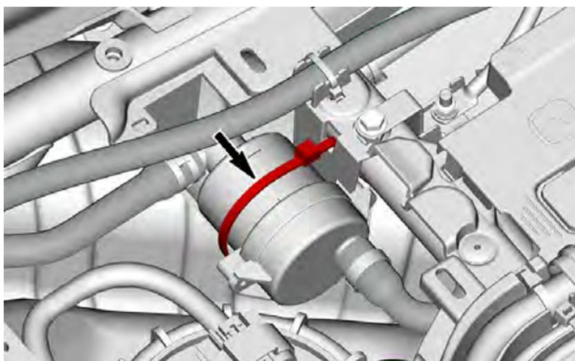
5. Durchtrennen Sie die Schellen, die den Schlauch am Filter sichern. Rangieren Sie die Oetiker-Schelle aus.
