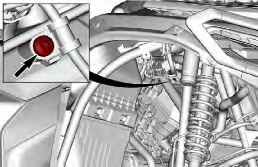
6. Ziehen Sie den Zündspulen-Steckverbinder ab.
