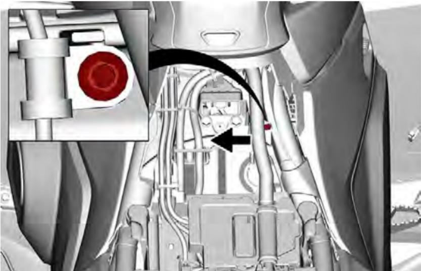
4. Ziehen Sie den Zündspulen-Steckverbinder ab.
