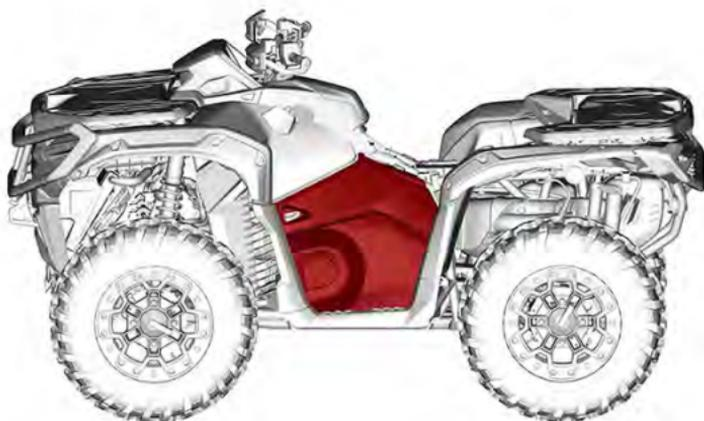
2. Entfernen Sie den linken inneren Kotflügel vorn.
