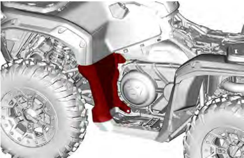
4. Ziehen Sie den Kühlluftfeinlassschlauch von der CVT-Abdeckung ab.
