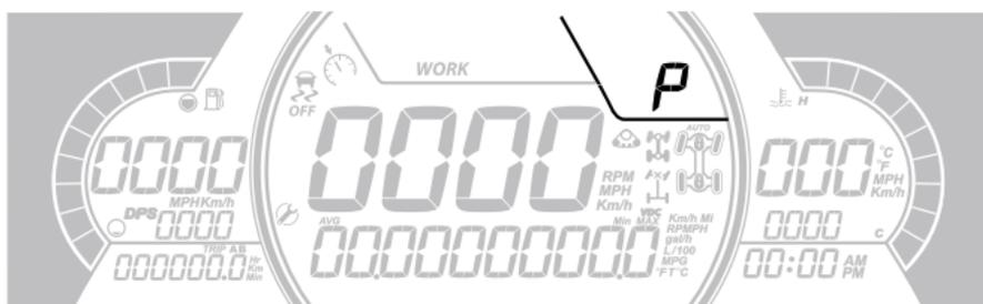
Diese Anzeige zeigt die Getriebestellung an:
