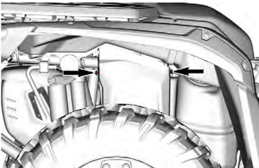
2. Entfernen Sie die Batterieabdeckung.
