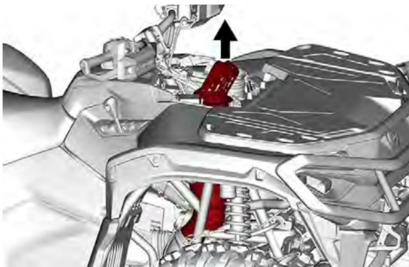
5. Entfernen Sie die Schraube der Zündspulenklemme.
