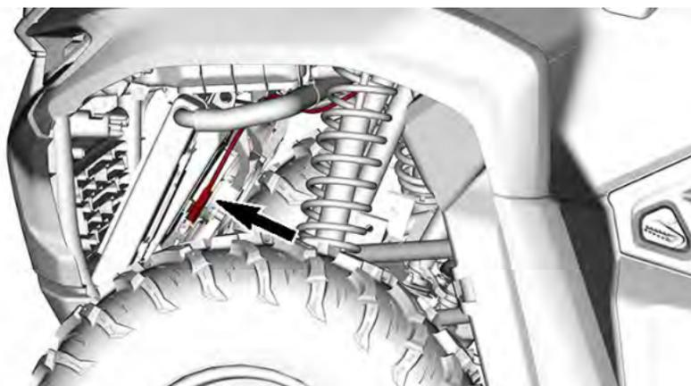
4. Ziehen Sie den Kühlerlüfter zur linken Seite des Fahrzeugs.
