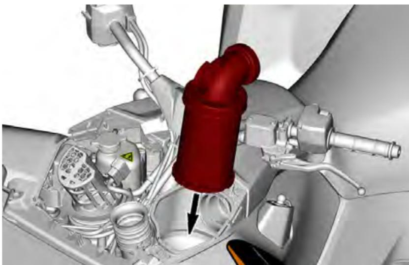
3. Drücken Sie den Luftfilteradapter mit Hilfe des Griffs fest in die Öffnung des Luftfiltergehäuses.
