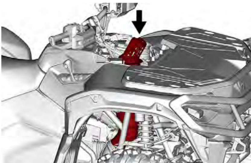
2. Montieren Sie die Kunststoffniete neben dem Sicherungskasten.
