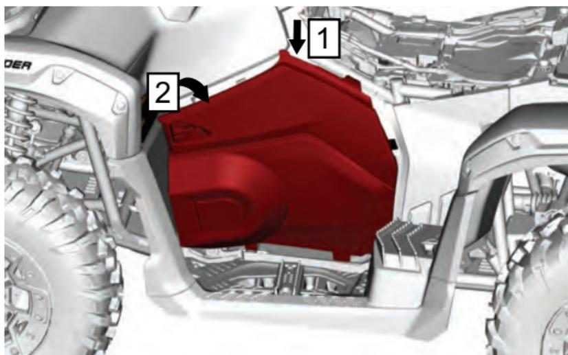
Schritt 1. Setzen Sie die Seitenverkleidung ein
