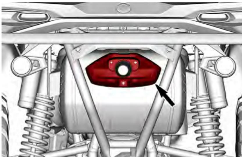
3. Bauen Sie den Funkenfänger aus und entsorgen Sie die Dichtung.
