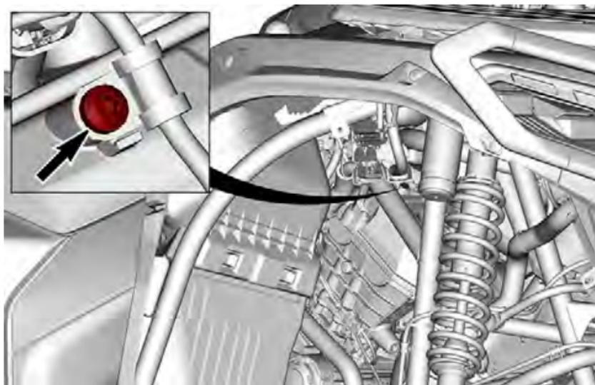
6. Desconecte el conector de la bobina de encendido.
