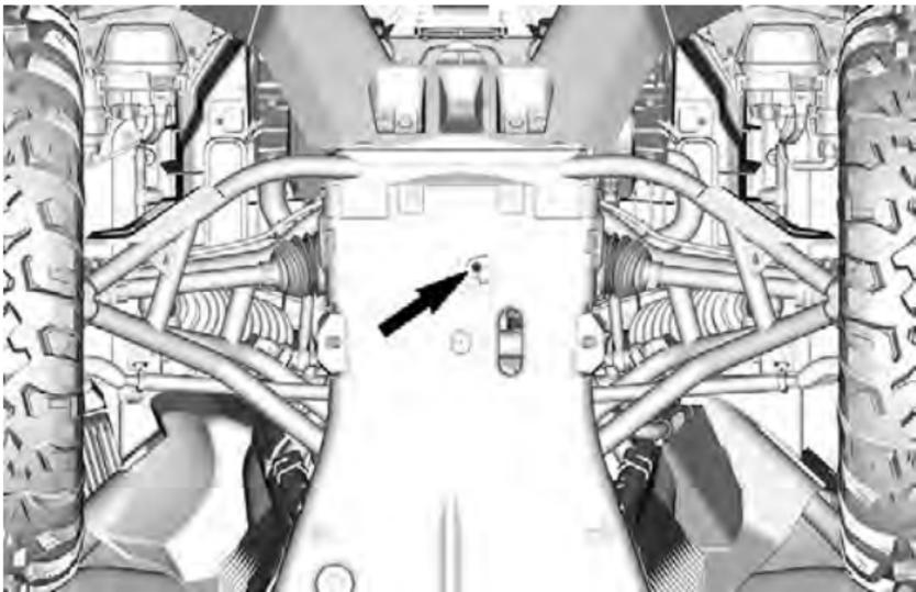
4. Coloque una bandeja de drenaje por debajo de la extensión del diferencial delantero.
