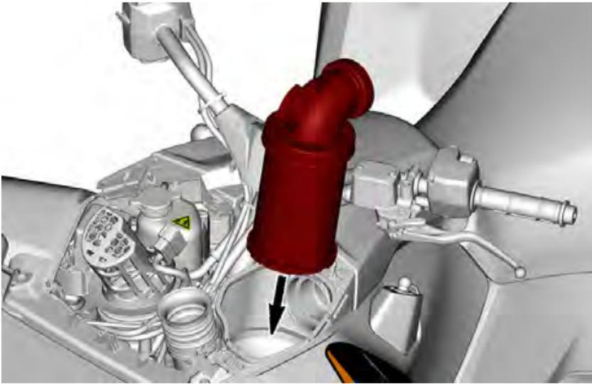
3. Utilice la manija para empujar firmemente el adaptador del filtro de aire en su carcasa.
