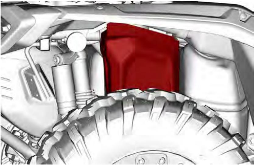
6. Asegure la cubierta de la batería con los remaches de plástico que quitó anteriormente.
