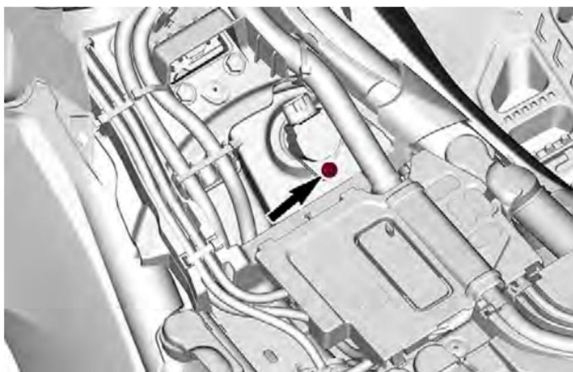
6. Extraiga la bobina de encendido.
