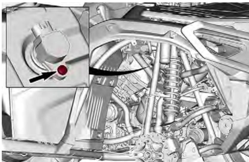
8. Extraiga la bobina de encendido.
