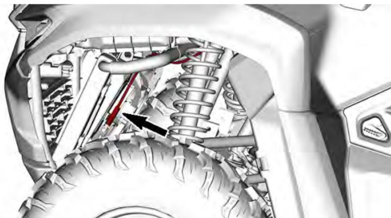
4. Mueva el ventilador del radiador hacia la parte izquierda del vehículo.
