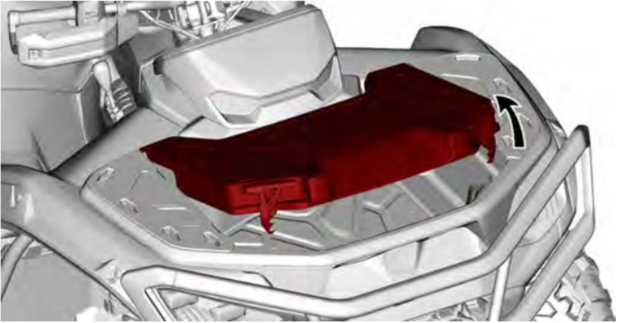
2. Gire la palanca que se encuentra dentro del compartimento, para asegurar la tapa en posición abierta.
