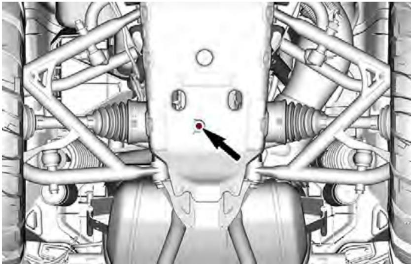
4. Coloque una bandeja de drenaje debajo de la extensión de la transmisión final trasera.
