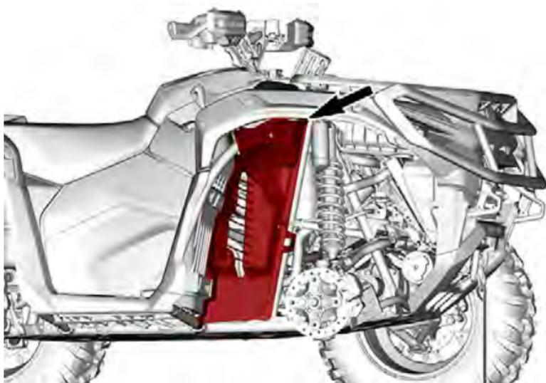
4. Retire el conducto de admisión de la transmisión CVT.
