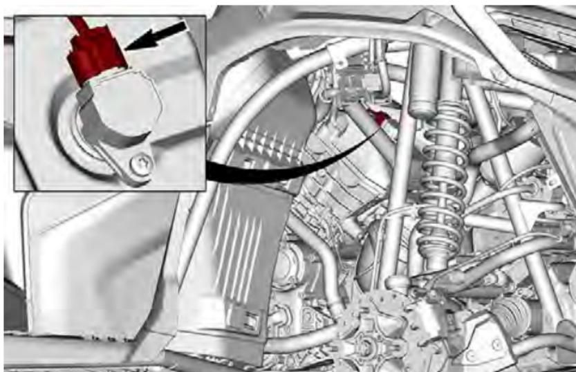
6. Instale el tornillo de la abrazadera del cable de la bobina.
