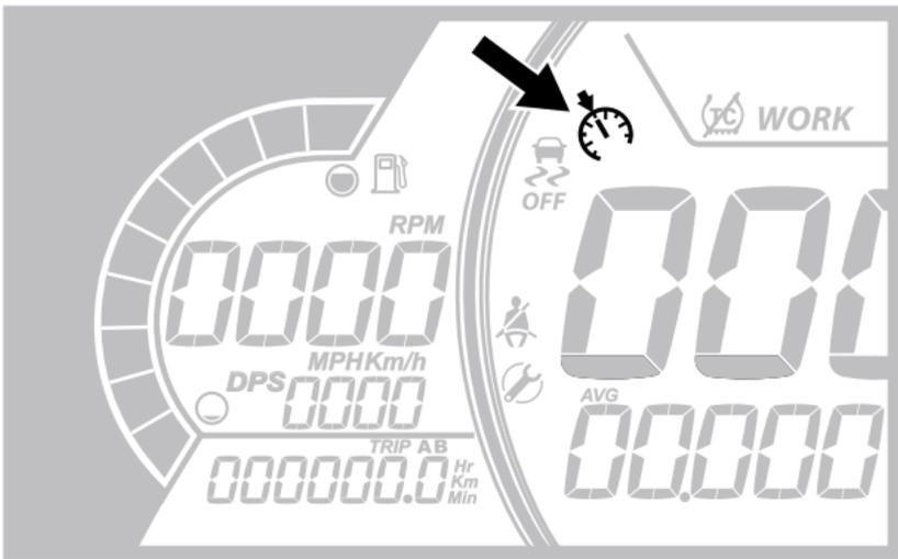
Con la activación del modo de limitador de velocidad solo se limita la velocidad máxima disponible cuando se pisa el acelerador.
