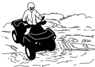
Si los frenos están húmedos, la capacidad de frenado del vehículo se ve afectada. Asegúrese de que se sequen los frenos; para ello, accíonelos varias veces después de salir del agua, del barro o de la nieve con el vehículo. Tenga en cuenta la necesidad de una mayor distancia para el frenado.
