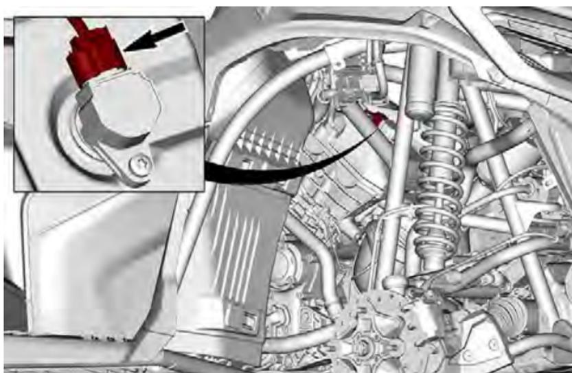
7. Quite el tornillo de sujeción de la bobina de encendido.
