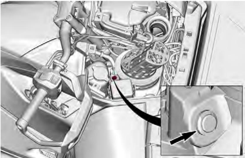
4. Levante el conducto de la transmisión CVT.
