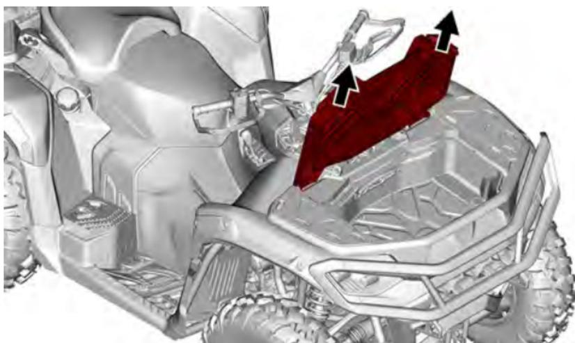
**Instalación de la tapa del compartimento delantero para almacenamiento**
