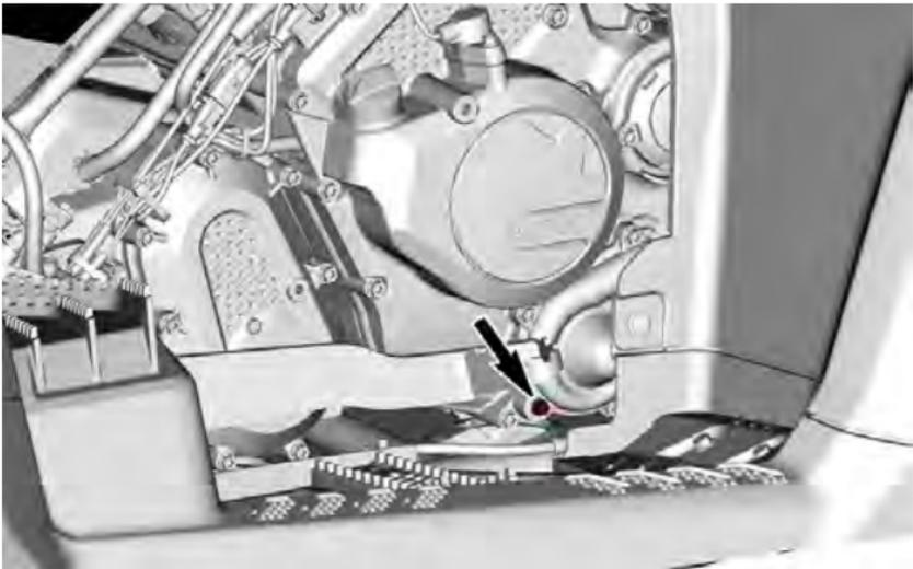
3. Desconecte la manguera inferior del radiador, de la cubierta de la bomba de agua y vacíe el refrigerante que quede en un recipiente adecuado. Deseche la abrazadera Oetiker.
