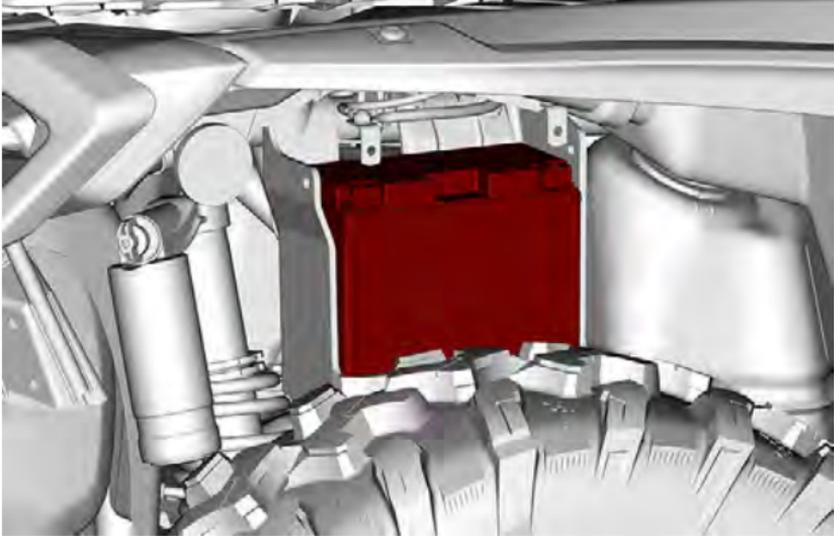
2. Asegure la batería con la correa de sujeción que trae.
