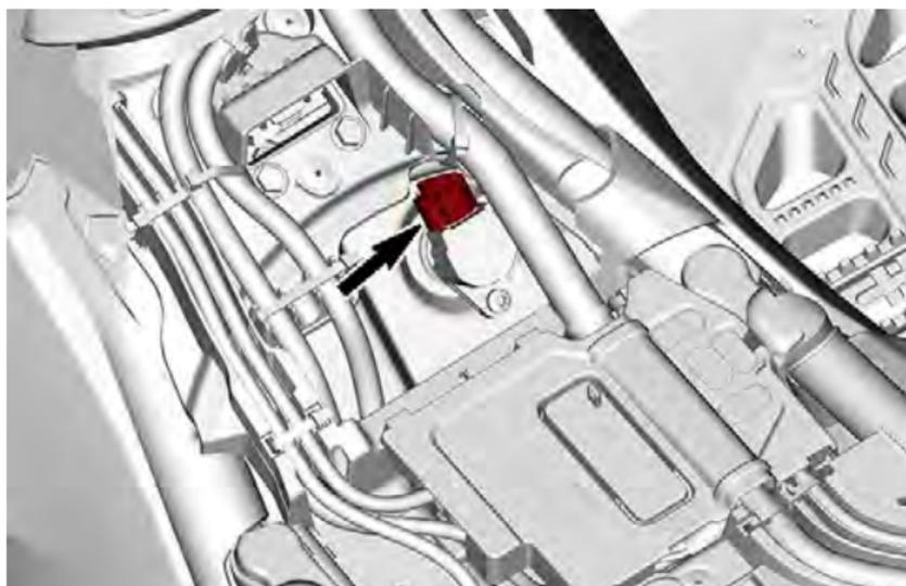
5. Quite el tornillo de sujeción de la bobina de encendido.
