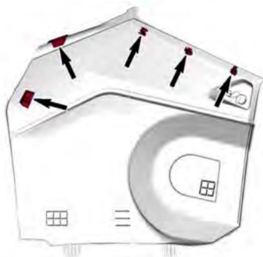
4. Incline el panel lateral hacia el exterior del vehículo y tire hacia arriba para retirarlo.
