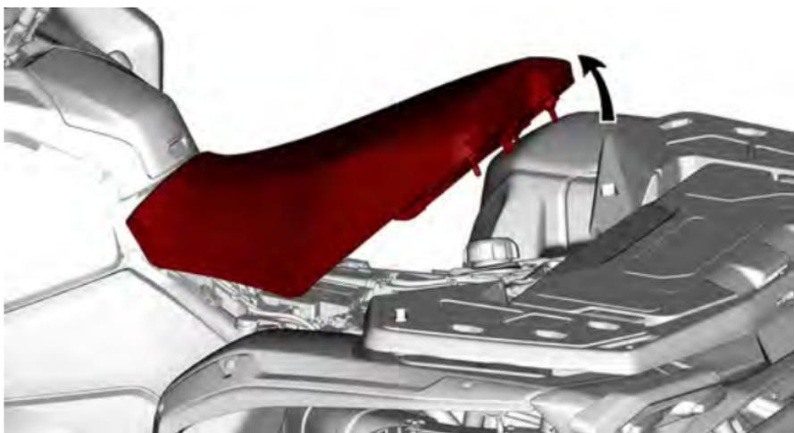
4. Tire del asiento hacia atrás para liberar la pestaña de retención delantera, y luego retire el asiento completamente.
