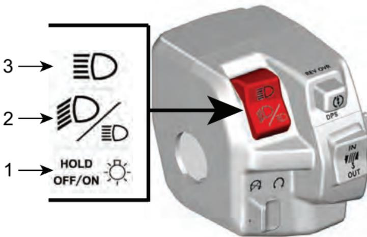
1. Reductor de luz/Faro apagado (OFF)
