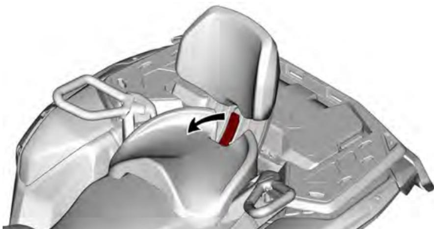
2. Mantenga la palanca del seguro presionada hacia delante y haga presión hacia abajo en la parte trasera de la palanca del seguro para liberar el seguro trasero y gire el asiento hacia adelante utilizando el respaldo.
