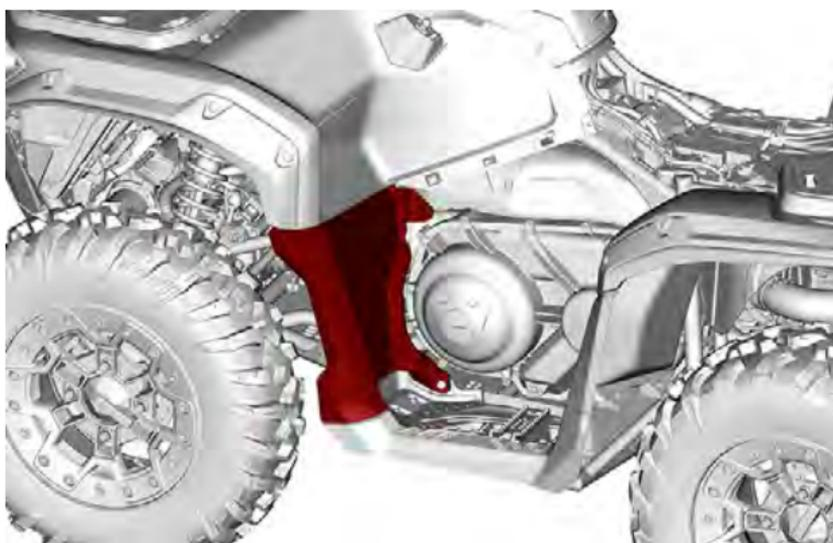
4. Desconecte de la cubierta de la transmisión CVT, el conducto de admisión de aire de refrigeración.
