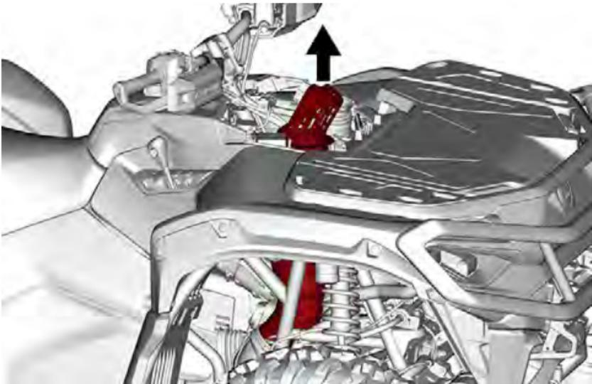
5. Retire el tornillo de la abrazadera del cable de la bobina.
