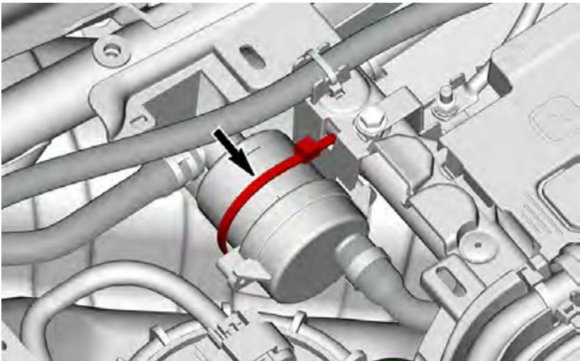
5. Retire las abrazaderas que sujetan las mangueras al filtro. Deseche la abrazadera Oetiker.
