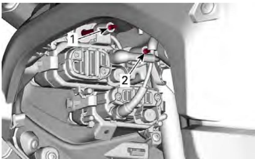
1. Tornillo de ajuste de luces bajas.
