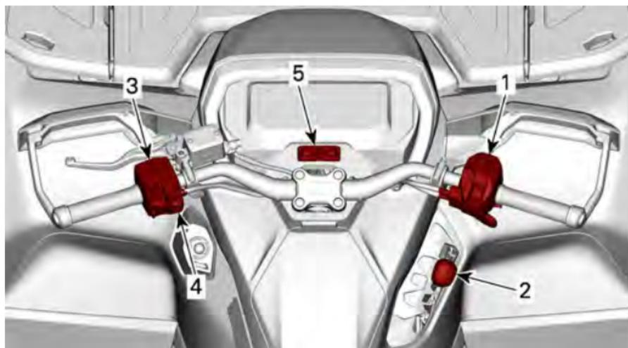
1. *Carcasa de control de la palanca de aceleración*
