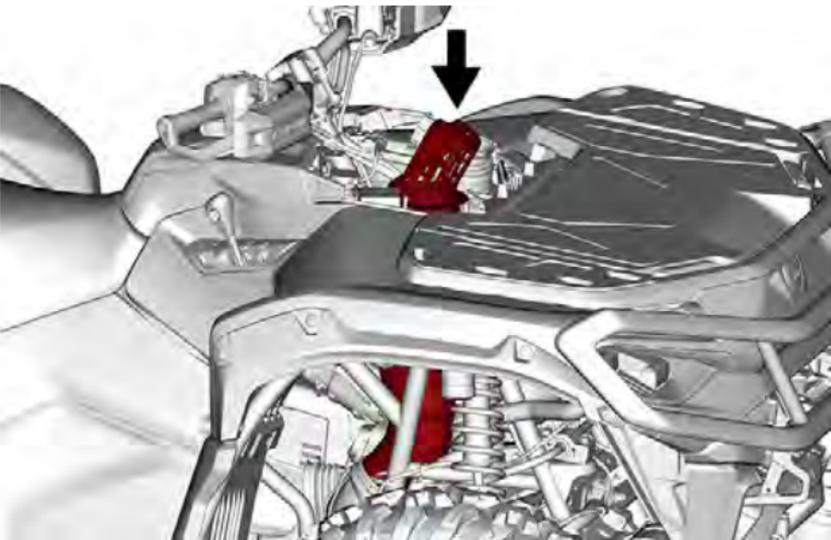
2. Instale los remaches de plástico que se encuentran al lado de la caja de fusibles.
