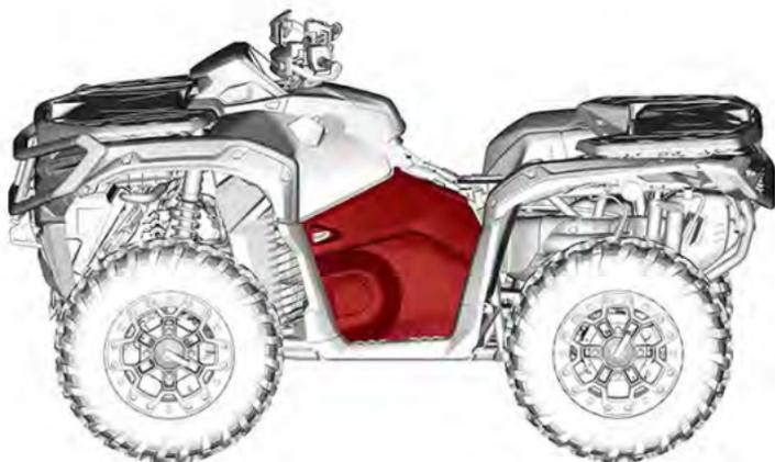
2. Remova o para-lama interno dianteiro esquerdo.
