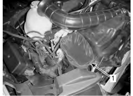
1. Filtro de aire de la CVT
