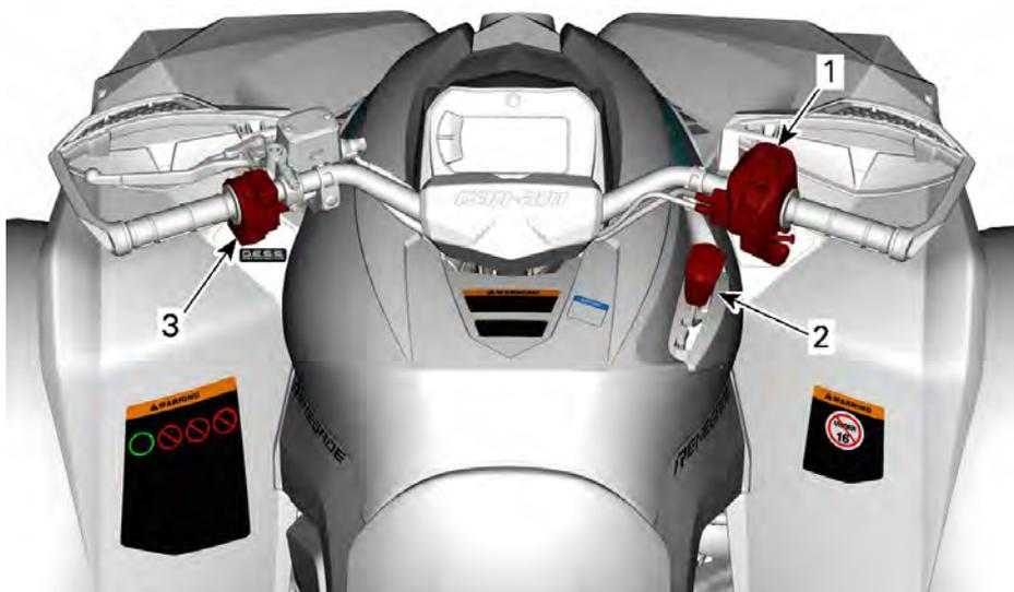
1. Alloggiamento del comando della leva dell'acceleratore
