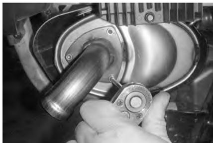
**CONFIGURAZIONE TIPICA - RIMUOVERE IL TUBO DI CODA**
