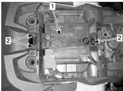
1. Fascetta di fissaggio della batteria
