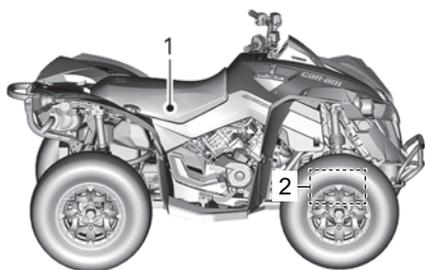
1. Etichetta VIN - Sul telaio sotto il sedile
