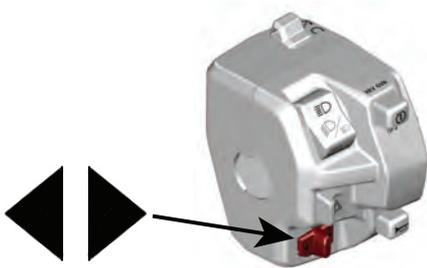
Schieben Sie die Taste für den linken Blinker nach links und für den rechten Blinker nach rechts.
