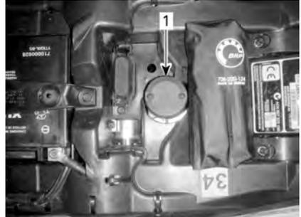
1. Behälter für Bremsflüssigkeit der hinteren Bremse
