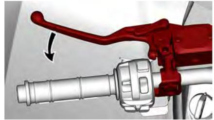
Die Bremswirkung ist proportional zur Kraft, die auf den Hebel ausgeübt wird.
