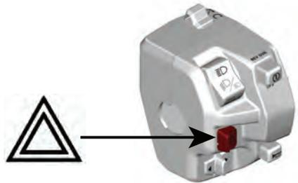
Schieben Sie die Taste zur Seite, um die Warnblinker zu aktivieren. Schieben Sie die Taste zur anderen Seite, um die Warnblinker auszuschalten.
