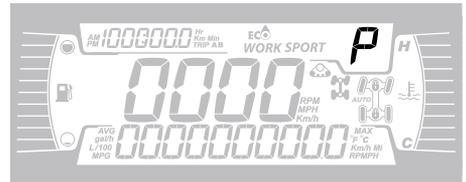
Diese Anzeige zeigt die Getriebestellung an:
