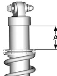
**A = FEDERVORSPANNUNG**
