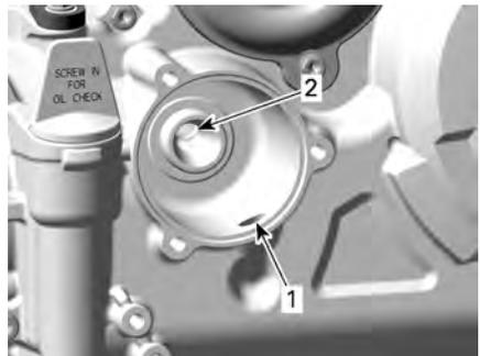
1. Einlass-Bohrung der Ölpumpe zum Ölfilter
