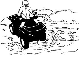
Nasse Bremsen beeinträchtigen die Bremsleistung Ihres Fahrzeugs. Sorgen Sie durch mehrfaches Betätigen dafür, dass Ihre Bremsen wieder trocken werden, nachdem das Fahrzeug das Wasser, Schlamm oder Schnee verlassen hat. Achten Sie beim Bremsen auf einen größeren Abstand.
