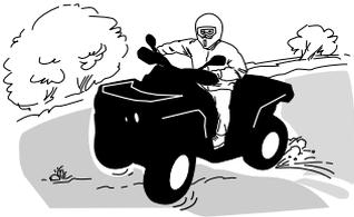
Si le véhicule se met à glisser, tournez le guidon dans la direction du glissement jusqu'à la reprise de la maîtrise du véhicule. Ne serrez jamais les freins à fond et ne bloquez jamais les roues.
