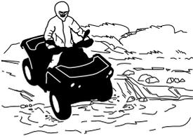
Si los frenos están húmedos, la capacidad de frenado del vehículo se ve afectada. Asegúrese de que se sequen los frenos; para ello, acciéndelos varias veces después de salir del agua, del barro o de la nieve con el vehículo. Tenga en cuenta la necesidad de una mayor distancia para el frenado.
