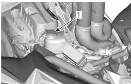
1. Tapón del depósito de refrigerante del motor
