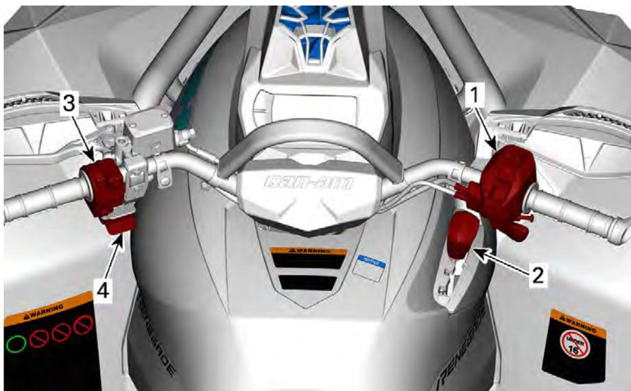
1. Carcasa de control de la palanca de aceleración
