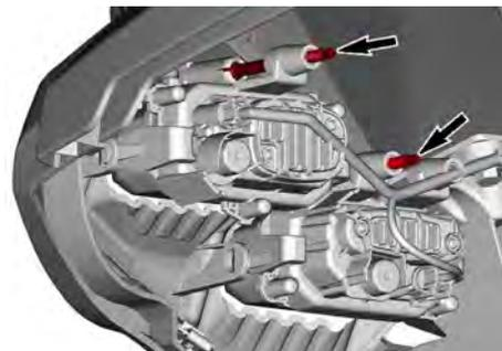
**Reemplazo de bombillas de las luces traseras/de freno**
