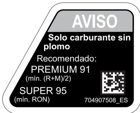
**MOTORES 1000R - CERCA DEL TAPÓN DEL DEPÓSITO DE COMBUSTIBLE**
