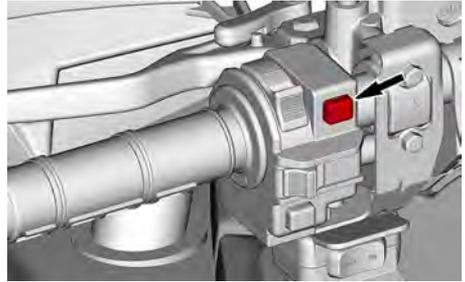
Cuando se presiona y se mantiene el tiempo necesario, arranca el motor.
