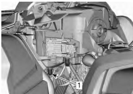
1. Tubo de vaciado del filtro de aire
