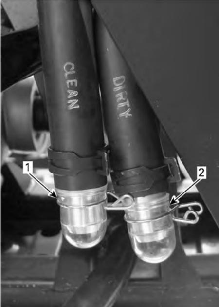
1. Reservatório de drenagem da caixa do filtro de ar
