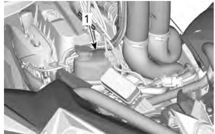
1. Reservatório do líquido de arrefecimento do motor
