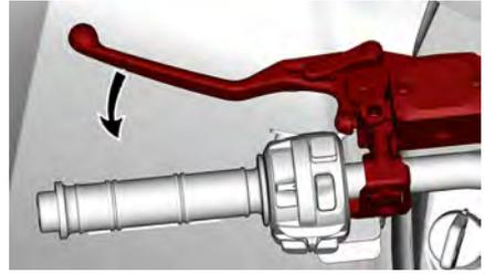
A frenagem é proporcional à força aplicada na alavanca.
