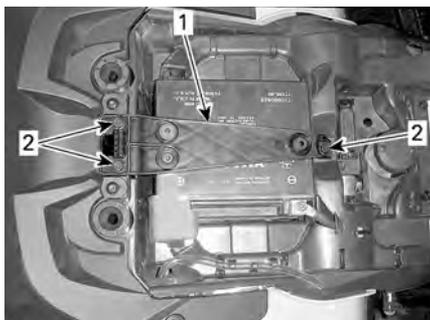
1. Fascetta di fissaggio della batteria
