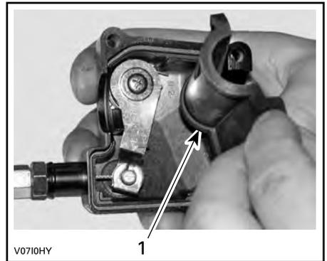
1. Protezione interna dell'alloggiamento
