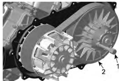
1. Strumento di traino/bloccaggio
