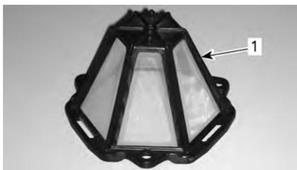
1. Filtro dell'aria CVT (tipo clip-on)
