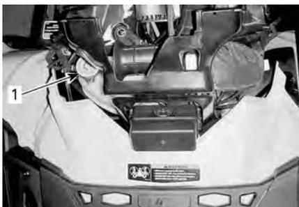
1. Tappo del serbatoio liquido refrigerante motore
