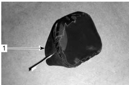
1. Filtro dell'aria CVT (tipo slip-on)
