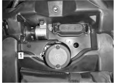
1. Behälter für Bremsflüssigkeit der hinteren Bremse
