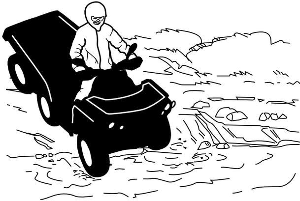
Nasse Bremsen beeinträchtigen die Bremsleistung Ihres Fahrzeugs. Sorgen Sie durch mehrfaches Betätigen dafür, dass Ihre Bremsen wieder trocken werden, nachdem das Fahrzeug das Wasser, Schlamm oder Schnee verlassen hat. Achten Sie beim Bremsen auf einen größeren Abstand.
