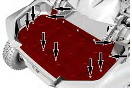
9. Remova os parafusos que prendem os defletores acústicos no suporte do intercooler e no chassi. Depois, remova o defletor de cada lado do intercooler.
