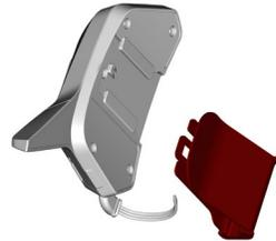
2. Sélectionnez les deux adhésifs caoutchouc monoface et installez-les au dos de l'appareil.
