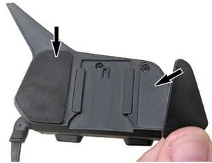
3. Trennen Sie beide Lautsprecher und das Mikrofon vom Hauptmodul. Ziehen Sie hierzu an beiden Enden des Steckverbinders.
