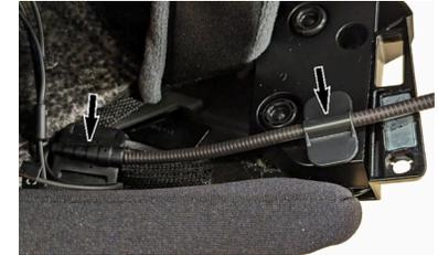
5. Verlegen Sie das Mikrofonkabel hinter dem Wangenpolster.
