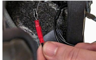
5. Stellen Sie sicher, dass der ROTE Steckverbinder korrekt angeschlossen ist und der Pfeil auf das Sena-Logo zeigt.
