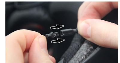
**B.6.** Stellen Sie sicher, dass beide Lautsprecherkabel hinter dem Polster verlaufen und beim Tragen oder Abnehmen des Helms nicht stören.
