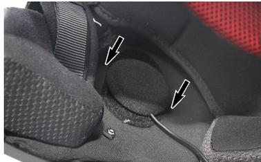
3. Positionieren Sie die Lautsprecher auf den zuvor angebrachten Klettverschlüssen und achten Sie darauf, dass die Lautsprecherkabel zur Rückseite des Helms zeigen.
