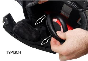
**A.7.** Verbinden Sie das Lautsprecherkabel wieder mit der SCHWARZEN Buchse der Haupteinheit. Wiederholen Sie den Vorgang auf der anderen Seite.
