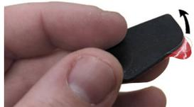
3. Entfernen Sie die Schutzfolie vom Klebeband oder Klettverschluss und kleben Sie die Haupteinheit auf. Üben Sie mindestens 30 Sekunden lang gleichmäßigen Druck aus.
