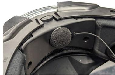
3. Positionieren Sie das Mikrofon auf dem im vorherigen Schritt angebrachten Klettverschluss.
