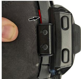
4. Entfernen Sie den Nackenschutz, indem Sie am hinteren Abschnitt ziehen und die 4 vorderen Laschen lösen.
