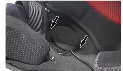
**B.4.** Positionieren Sie den Lautsprecher im Helm so, dass Sie einen möglichst hohen Komfort und eine hohe Soundqualität erhalten.
