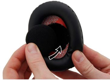
**A.6.** Setzen Sie die Geräuschkämpfung wieder in den Helm und achten Sie darauf, dass sich die Öffnungen unten am Helm befinden und das Lautsprecherkabel hinten zum Helm zeigt.
