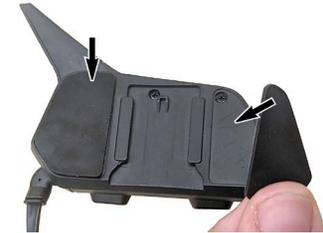
3. Trennen Sie beide Lautsprecher und das Mikrofon vom Hauptmodul. Ziehen Sie hierzu an beiden Enden des Steckverbinders.
