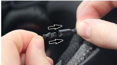
**A.8.** Asegúrate de que ambos cables de los altavoces pasen por debajo del revestimiento protector interior, y no molesten al colocarse o quitarse el casco.
