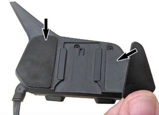
3. Desconecta del módulo principal los dos altavoces y el micrófono, jalando de ambos extremos del conector.
