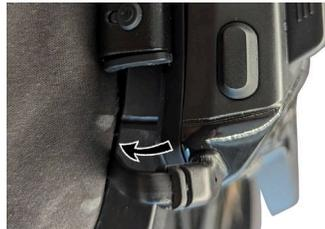
5. Para el casco con CIRCULACIÓN DE AIRE, se recomienda colocar el módulo principal por debajo del accesorio rojo del collar protector (pasa la pinza entre la carcasa del casco y el collar protector).
