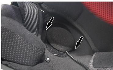
4. Vuelve a acoplar el cable del altavoz con el conector hembra NEGRO de la unidad principal. Repite la acción en el otro lado.
