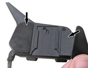
3. Scollegare i due altoparlanti e il microfono dal modulo principale tirando entrambe le estremità del connettore.
