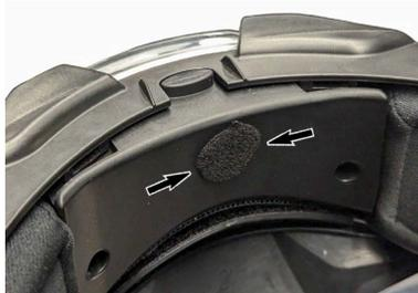
3. Posizionare il microfono sul Velcro installato nel punto precedente.
