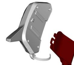
2. Selezionare i 2 adesivi in gomma monolaterali e installarli sul retro del dispositivo.
