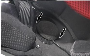
3. Posizionare gli altoparlanti sui fissaggi in Velcro precedentemente installati, assicurandosi che i fili degli altoparlanti siano rivolti verso la parte posteriore del casco.
