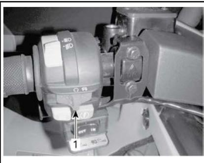
1. Interruptor de emergência de desligamento do motor
