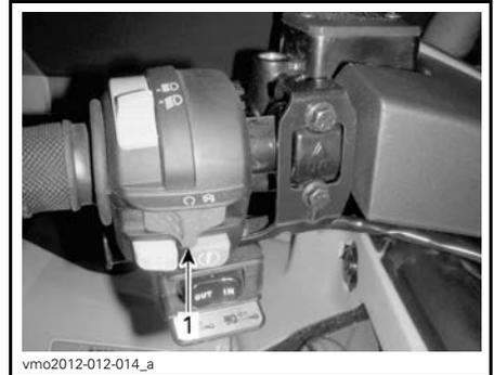
1. Interrupteur d'arrêt d'urgence du moteur
