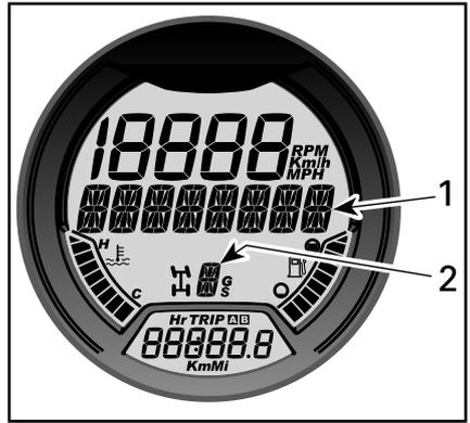
1. **AIR\_SUSP** (Luftfederung) wird angezeigt
