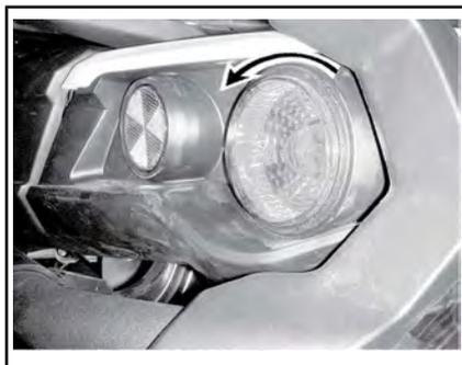
*RÜCKLEUCHE ZUM ENTFERNEN GEGEN DEN UHRZEIGERSINN DREHEN*
