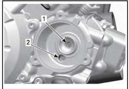
1. Auslass-Bohrung zur Ölspeisung des Motors
