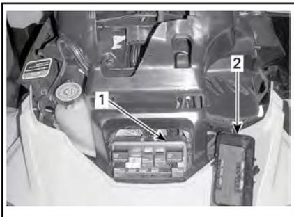
1. Vorderer Sicherungskasten
