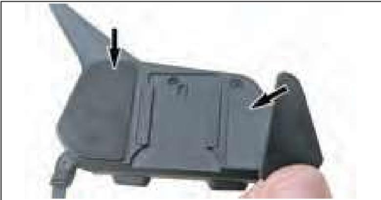
3. Débranchez les deux haut-parleurs et le microphone du module principal en tirant sur les extrémités du connecteur.
