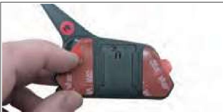
B.2. Nettoyez la surface avec le l'alcool isopropylique. Retirez la pellicule protectrice des bandes adhésives (double face), ou Velcro. Exercez une pression uniforme pendant au moins 30 secondes.
