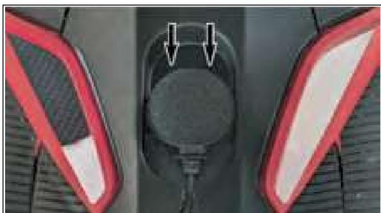
4. Passez le fil du microphone à travers la fente derrière le coussinet de joue.
