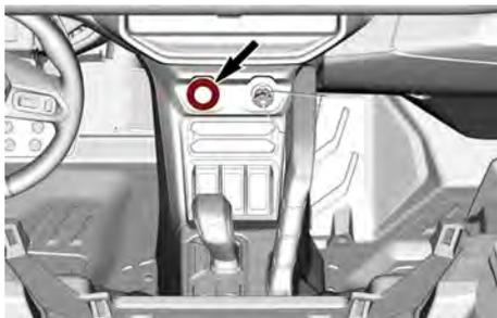
La clé D. E. S. S. étant insérée, appuyez sur le bouton de DÉMARRAGE/ARRÊT DU MOTEUR et maintenez-la enfoncée jusqu'à ce que le moteur démarre.
