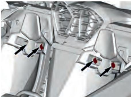
4. Retirez les quatre vis, deux derrière chaque siège, qui fixent le support du refroidisseur d'air à la cloison centrale arrière.
