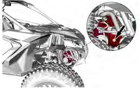
4. Retirez le bouchon de niveau d'huile et le joint torique.
