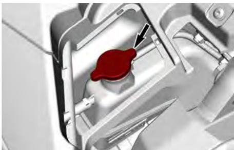
2. Ajoutez du liquide de refroidissement jusqu'à ce que le niveau atteigne la ligne MAX sur le réservoir de liquide de refroidissement. Reportez-vous à *Liquide de refroidissement recommandé*. Utilisez un
