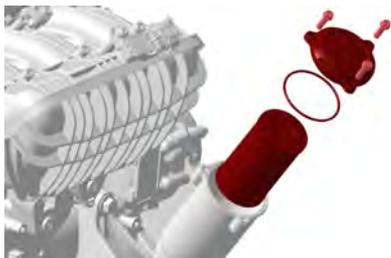
2. Retirez le couvercle du filtre à huile. Mettez au rebut le joint torique.
