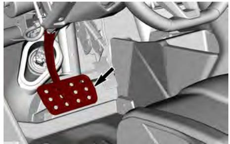
La pédale de frein permet de ralentir ou d'arrêter le véhicule.
