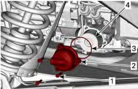
1. Schrauben der Ölfilterabdeckung
