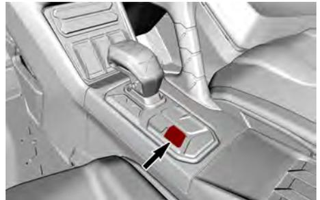
Mit dieser Taste wird das Getriebe in die Neutralstellung gebracht.
