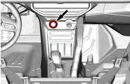
Halten Sie die START-/STOPP-Taste des MOTORS bei eingestecktem D.E. S.S. Schalter gedrückt, um den Motor zu starten.
