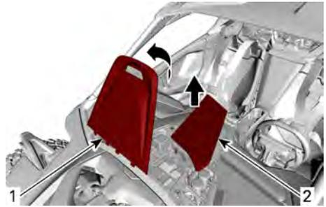
1. Abdeckung des Sicherungskastens
