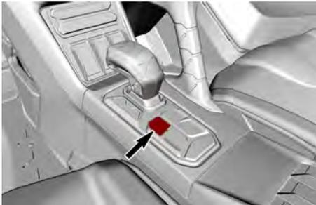
Mit dieser Taste wird das Getriebe in die PARK-Stellung gebracht.
