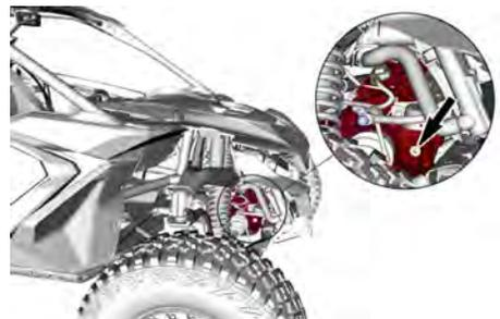
4. Entfernen Sie die Füllstandschraube und den O-Ring.
