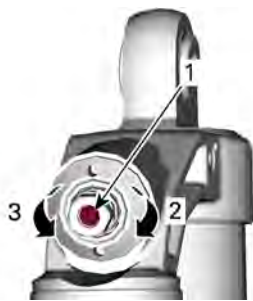
AMORTISSEMENT DE LA COMPRESSION À BASSES VITESSES (À L'AIDE D'UN TOURNEVIS)
