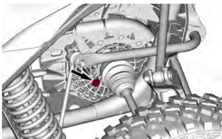
4. Rimuovere il tappo livello olio della trasmissione finale posteriore e l'O-ring.
