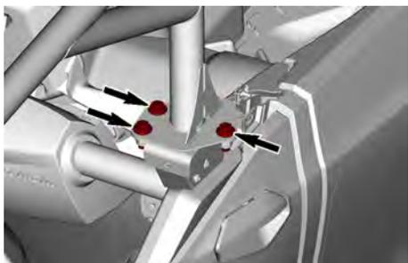
**DISPOSITIVI DI FISSAGGIO CENTRALI INFERIORI – CONFIGURAZIONE TIPICA**
