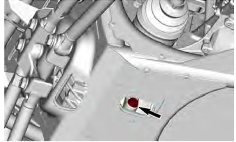
5. Posizionare una vaschetta di raccolta sotto la zona del tappo di scarico magnetico.
