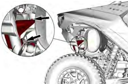
**VITI DELLO SCARICO - LATO DESTRO (CONFIGURAZIONE TIPICA)**
