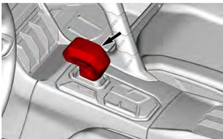
La leva viene utilizzata per mettere la trasmissione in posizione di marcia in avanti o retromarcia.
