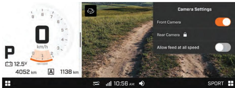
Guidare in avanti controllando solo l'immagine della telecamera anteriore dal display potrebbe causare un incidente.
