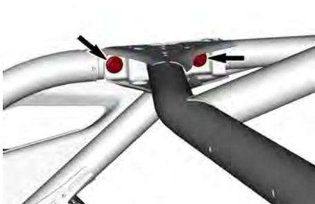
**DISPOSITIVI DI FISSAGGIO LATERALI POSTERIORI – CONFIGURAZIONE TIPICA**
