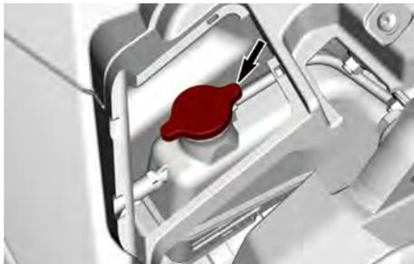
2. Aggiungere liquido di raffreddamento quando il livello del liquido raggiunge il riferimento MAX sul serbatoio del refrigerante. Fare riferimento a *Liquido refrigerante motore consigliato*. Usare un imbuto per impedire le perdite di liquido. **Non riempire eccessivamente.**
