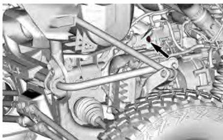
4. Inserire la chiave Torx T30 (contenuta nel kit di attrezzi del veicolo) nell'estremità dell'albero del cambio attraverso il foro di accesso.
