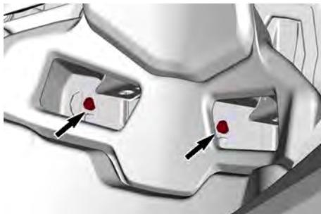
5. Rimuovere il rivetto di plastica sulla parte superiore della griglia della presa d'aria.
