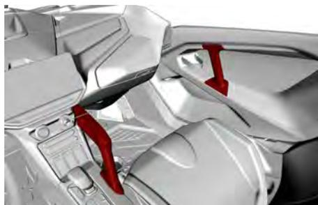
L'utilizzo delle maniglie aiuta il passeggero a prepararsi al movimento del veicolo e a mantenere le mani e il corpo all'interno del cockpit in caso di ribaltamento.
