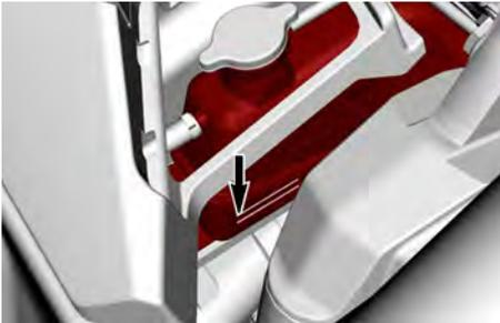
4. Aggiungere liquido refrigerante nel serbatoio se necessario. Fare riferimento a *Spurgo e riempimento del sistema di raffreddamento*
