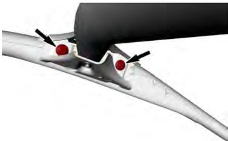
**DISPOSITIVI DI FISSAGGIO LATERALI ANTERIORI – CONFIGURAZIONE TIPICA**
