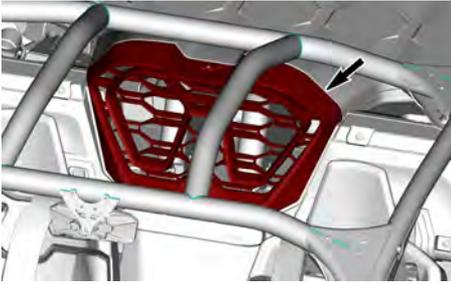
7. Rimuovere i rivetti in plastica e le viti che fissano il gruppo presa d'aria al portapacchi. Quindi rimuovere il gruppo presa d'aria.
