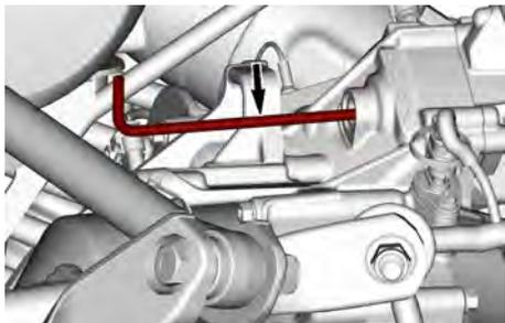
5. Ruotare la chiave Torx T30 verso il lato conducente (sinistra del veicolo) fino a quando la chiave si ferma.
