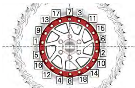
TYPISCH - AANDRAAIVOLGORDE
