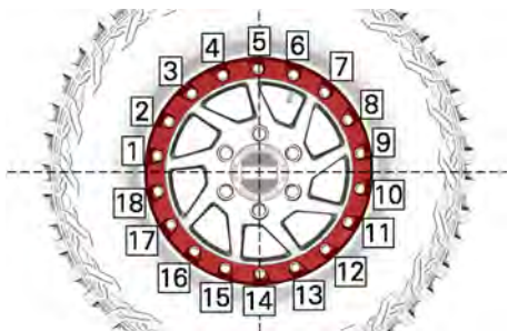
TYPISCH - LAATSTE AANDRAAIVOLGORDE
