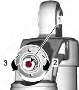
COMPRESSIEDEMPING BIJ LAGE SNELHEID (GEBRUIK EEN SCHROEVENDRAAIER)
