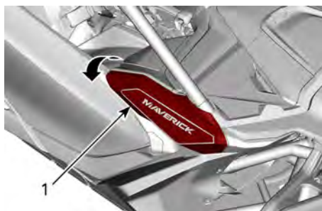
1. Cobertura da tampa do reservatório de combustível
