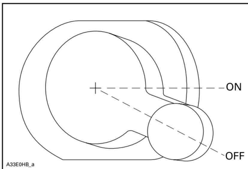
Alle Fahrer des Motorschlittens sollten sich mit der Funktion des Motor-Notausschalters vertraut machen, indem sie ihn mehrere Male beim ersten Ausflug und immer wieder danach zum Ausschalten des Motors benutzen. Diese Vorgehensweise zum Ausschalten des Motors wird so zu einer reflexartigen Handlung, und Sie sind in Notsituationen auf seine Verwendung vorbereitet.
