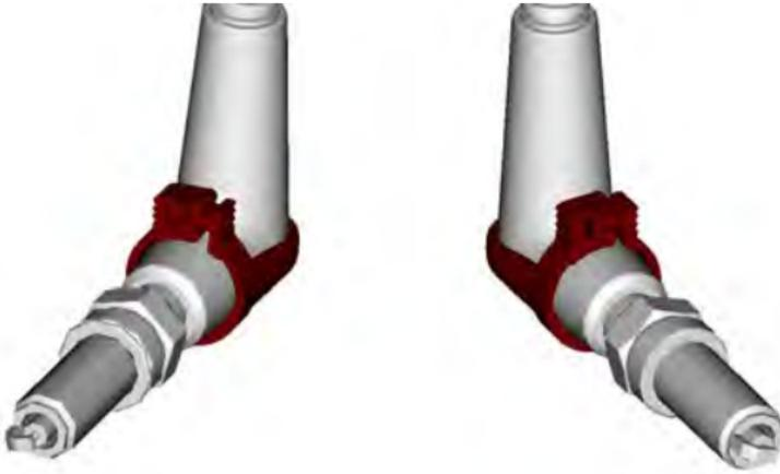
5. Bauen Sie die Zündkerzenkabel aus, indem Sie die Kappe leicht drehen und von der Zündkerze abziehen.
