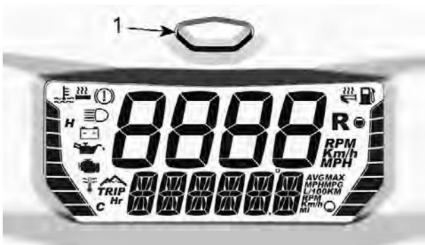
1. Modus-Taste des Anzeigeeinstruments
