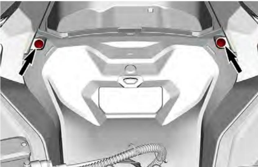
2. Heben Sie die Vorderseite der Anzeiginstrumenthalterung an und schieben Sie diese anschließend nach vorne, um sie abzunehmen.
