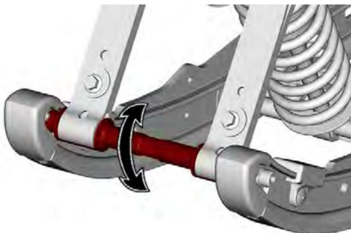
3. Ziehen Sie die Schrauben der Achse nach Vorgabe an.
