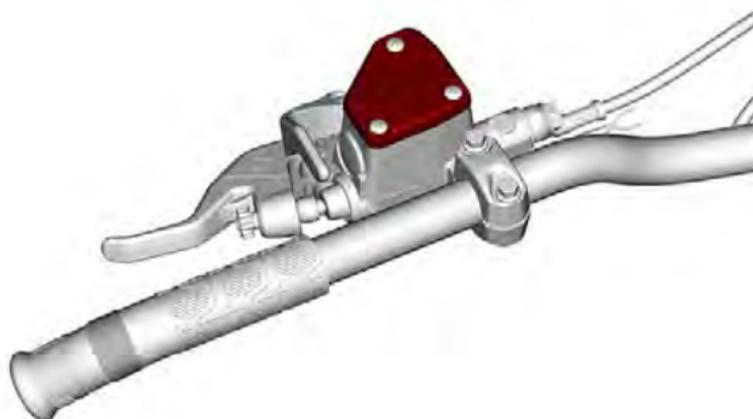
2. Entfernen Sie die Halteschrauben des Behälterdeckels.
