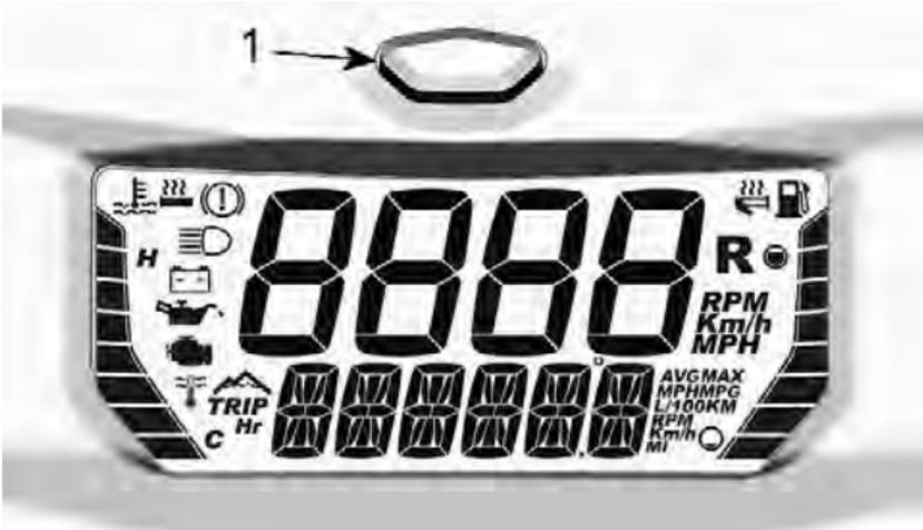
1. Modus-Taste des Anzeigeinstruments
