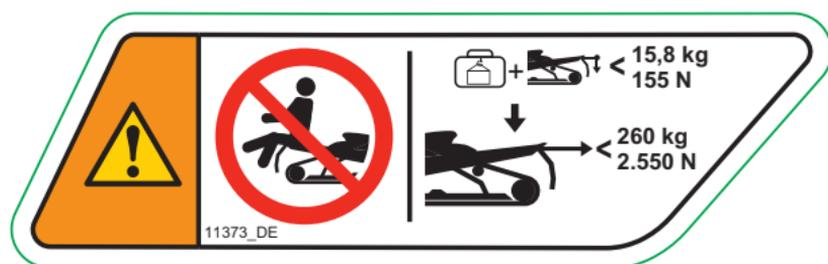
**MAXIMALE ZULADUNG UND ZUGLAST - WARNSCHILD**
