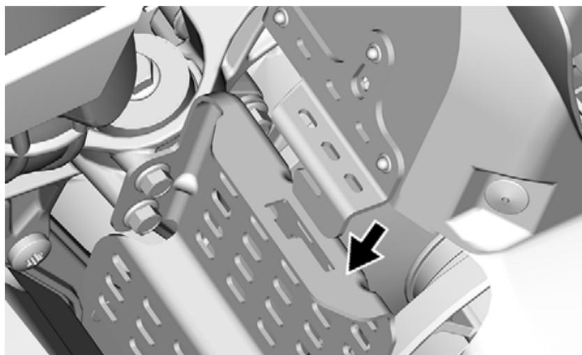
Schieben Sie die Antriebsriemenabdeckung in Richtung Motor und dann in Richtung der Fahrzeugfront.
