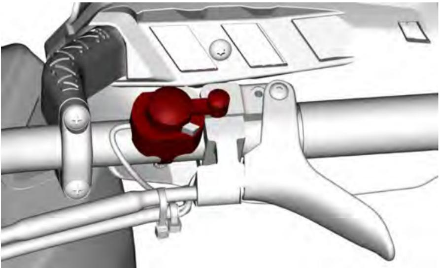
Um den Motor in einem Notfall anzuhalten, ist die OFF-Stellung (AUS) zu wählen und gleichzeitig die Bremse anzuziehen. Um den Motor wieder anzulassen, muss sich der Schalter in der Stellung ON (EIN) befinden.
