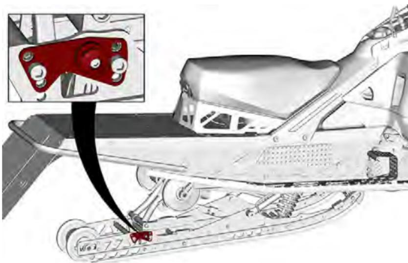
Durch das Zusammendrücken der Federung ist mehr Kraft erforderlich, um eine Bewegung einzuleiten. Das Ergebnis ist eine schnellere Gewichtsübertragung, so dass die Kraft schneller auf den Boden übertragen wird.
