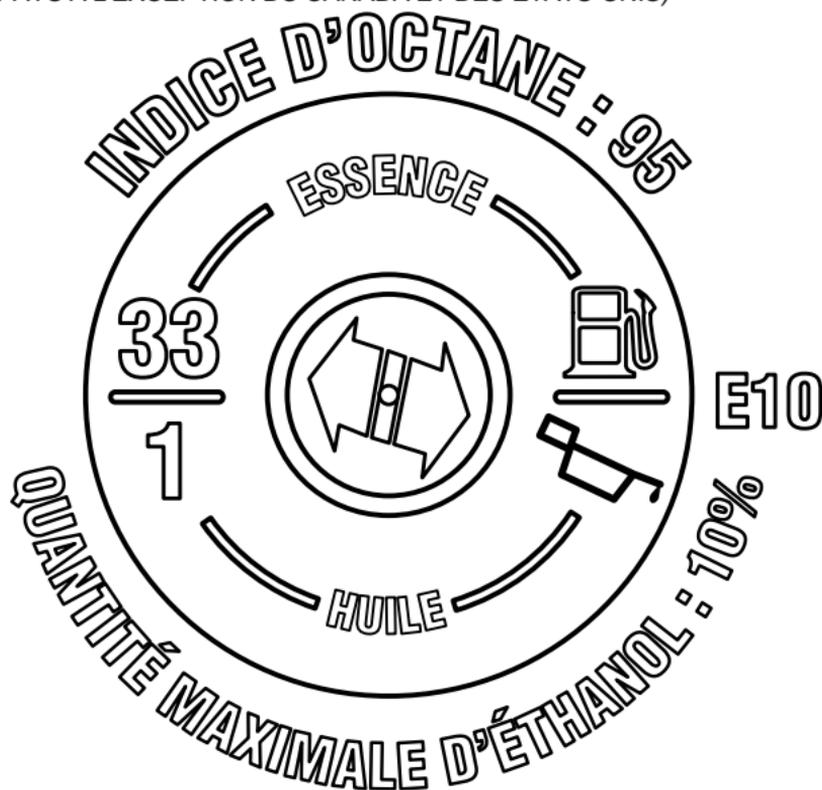
**SUR LE BOUCHON DU RÉSERVOIR DE CARBURANT - DANS LES PAYS UTILISANT DES INDICES D'OCTANE RON AFFICHÉS À LA POMPE**
