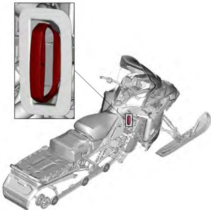
Le type d'enroulement automatique est situé sur le côté droit de la motoneige, sous le panneau latéral. Ouvrez le panneau latéral droit pour accéder à la poignée du démarreur à rappel. Reportez-vous à *Dépose des panneaux latéraux* dans cette sous-section. Pour enclencher le mécanisme, tirez lentement sur la poignée jusqu'à ce que vous sentiez une résistance, puis tirez vigoureusement. Relâcher la poignée lentement.
