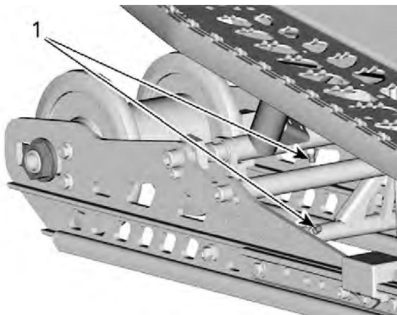
1. Raccords de graissage
