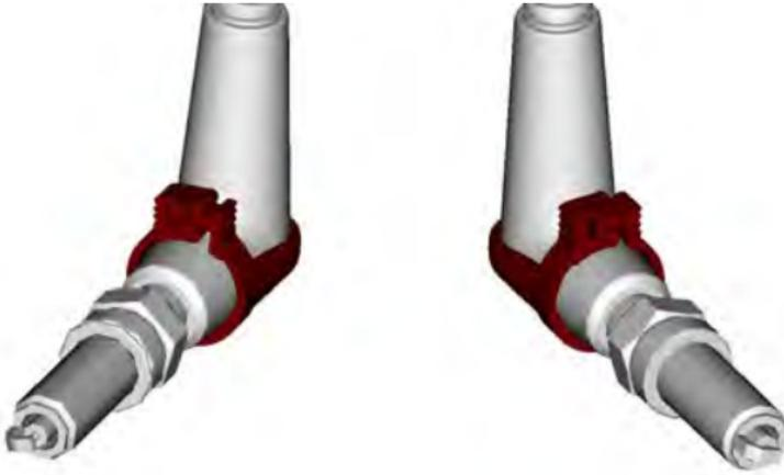
5. Retirez les câbles de bougie en tournant doucement le capuchon et en le retirant de la bougie.
