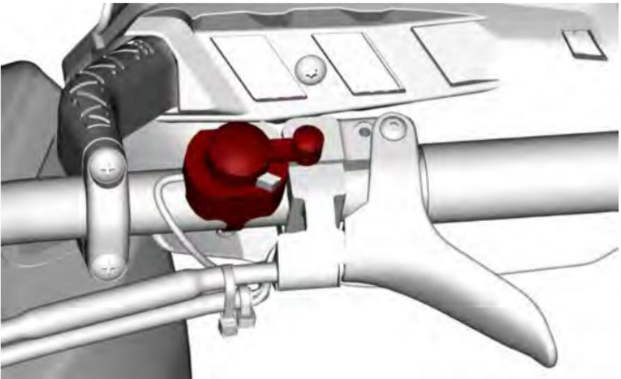
Pour arrêter le moteur en cas d'urgence, sélectionnez la position OFF et freinez en même temps. Pour redémarrer, le bouton doit être sur la position ON.
