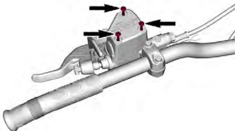
3. Retirez le bouchon de réservoir.
