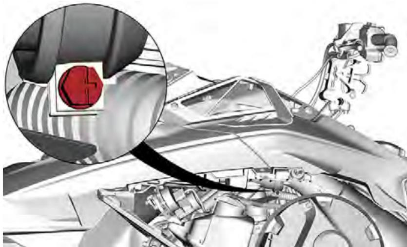
7. Retirez les vis de fixation du module de carrosserie supérieur des deux côtés.
