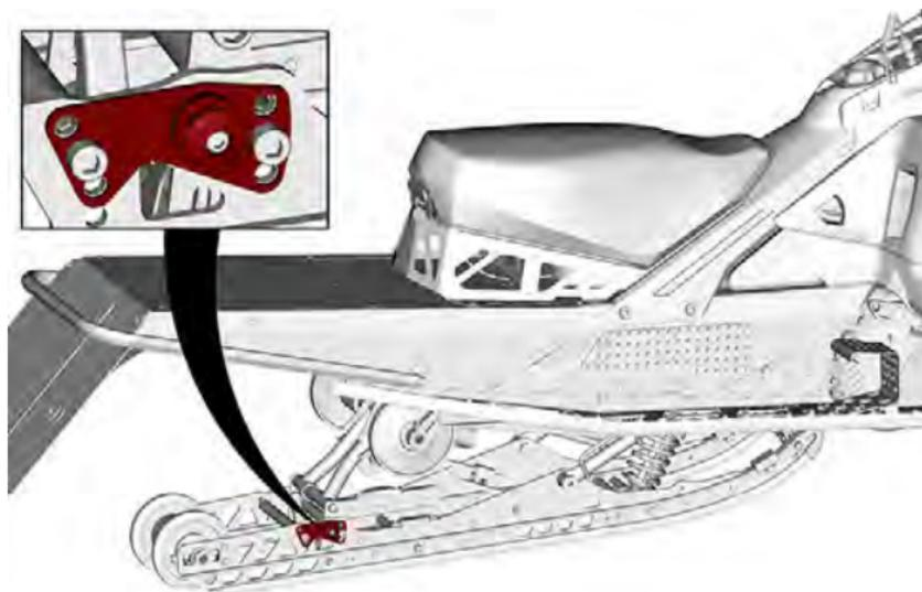
En comprimant la suspension, il exige une plus grande force pour déclencher son mouvement. Il en résulte un transfert de poids plus rapide, et par conséquent une transmission accélérée de la puissance au sol.
