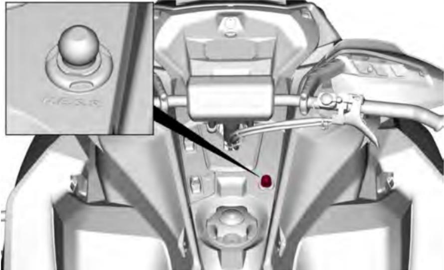
Le capuchon du cordon coupe-circuit doit être fermement rattaché à l'interrupteur de coupure du moteur pour pouvoir faire fonctionner le véhicule.
