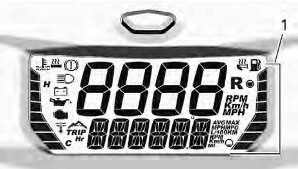
1. Søylemåler høyre side
