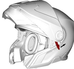
2. Setzen Sie das Sonnensvisier zwischen Innen- und Außenschale des Helms ein und lassen Sie es auf beiden Seiten auf dem Haltezapfen einrasten.
