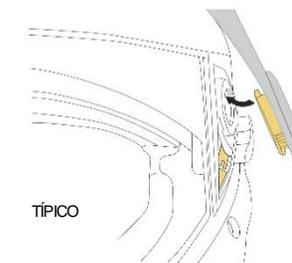
2. Assim que a aba estiver na posição, puxe a alavanca do mecanismo do protetor facial para baixo e empurre levemente a parte inferior do protetor facial para colocar a aba inferior de volta na posição.
