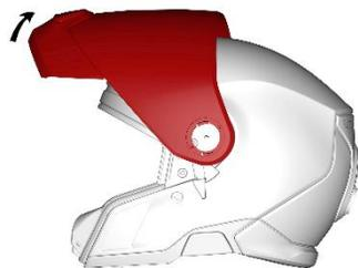
6. De um lado, puxe a alavanca do mecanismo do protetor facial para baixo para soltar a aba inferior do protetor.
