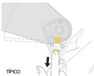
7. Mova a parte inferior dos pivôs do protetor facial para cima até que a aba inferior se solte do mecanismo.
