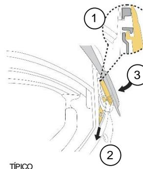
3. Em seguida, solte a alavanca. Certifique-se de que a mola a empurra de volta na posição para cima e verifique se a viseira está presa corretamente no lugar.
