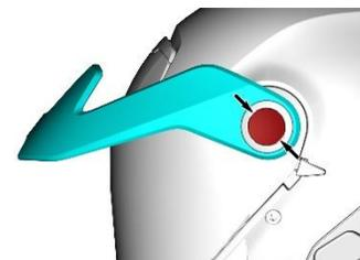
2. Se o capacete estiver equipado com uma pala, remova o parafuso da pala girando a parte externa por um quarto no sentido anti-horário.
