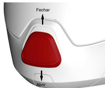
2. **ABERTO:** As ventilações inferiores podem ser ajustadas em 3 posições. Ao colocar os dois botões deslizantes na posição «
