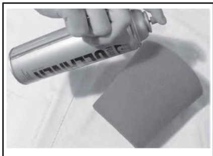
TYPISCH - SCHAUMSTOFFFILTERELEMENT BESPRÜHEN
