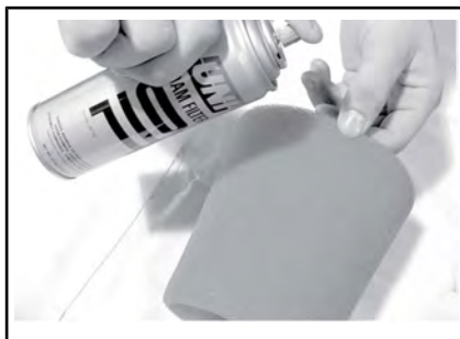
TYPISCH - SCHAUMFILTERELEMENT ÖLEN
