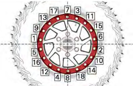
TYYPILLINEN KIRISTYSJÄRJESTYS
