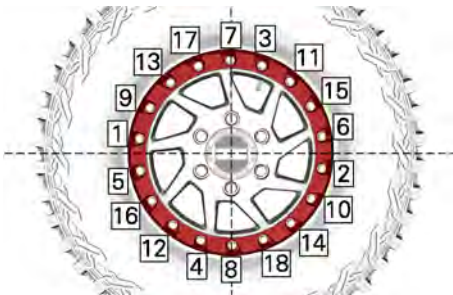
TYYPILLINEN KIRISTYSJÄRJESTYS
