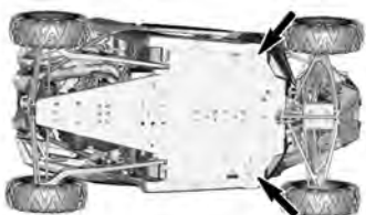
TUNKKIEN SIJAINNIT – AJONEUVON ETUOSA
