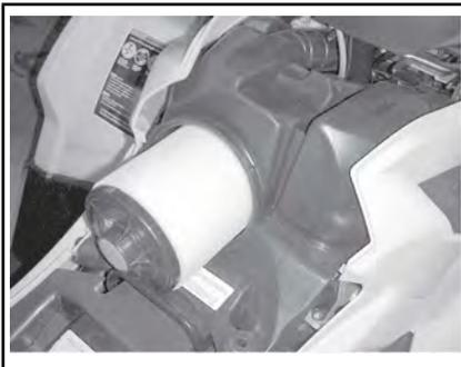
**REMOÇÃO DO FILTRO DE AR****Limpeza e lubrificação do filtro de ar**
