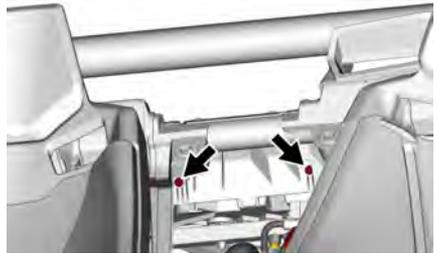
Entfernen Sie die Schutzplatte.
