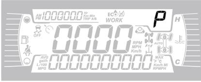
Diese Anzeige zeigt die Getriebestellung an:
