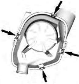
Entfernen Sie die Filterpatrone.
