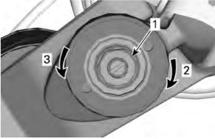
**AMORTECIMENTO POR COMPRESSÃO EM ALTA VELOCIDADE (USE UMA CHAVE INGLESA DE 17 MM)**
