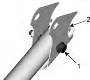
**MECANISMO DE AJUSTE DIANTEIRO NA POSIÇÃO BAIXA**
