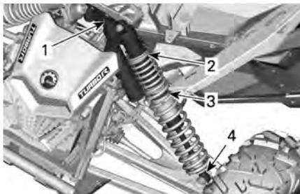
**TÍPICO - COM AMORTECIMENTO DO REBOTE - SUSPENSÃO DIANTEIRA**
