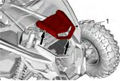
2. Inspeção o radiador e as mangueiras quanto a vazamentos e danos.
