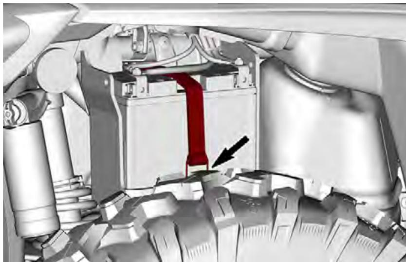
3. 赤の (+) バッテリーケーブルを先に接続し、その後に黒の (-) バッテリーケーブルを接続します。
