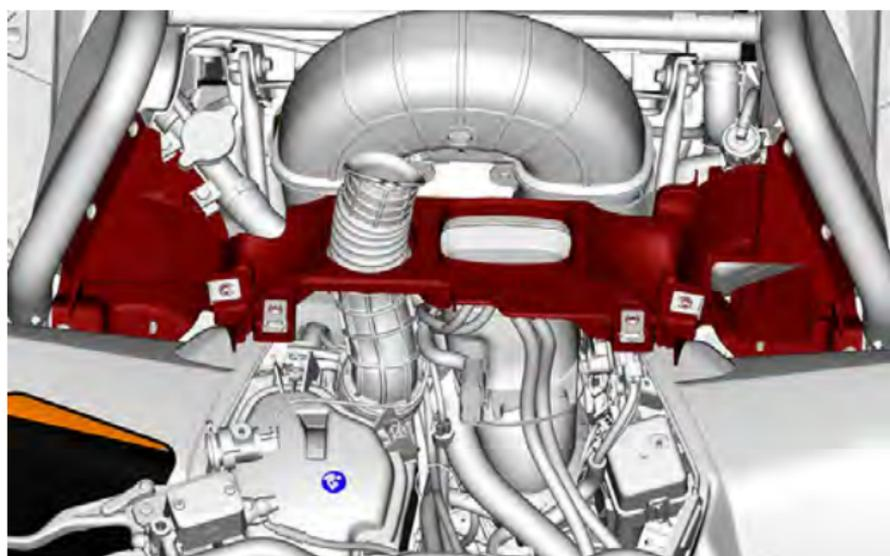
1. サポートの両側にある取り付けボルトを取り外します。
