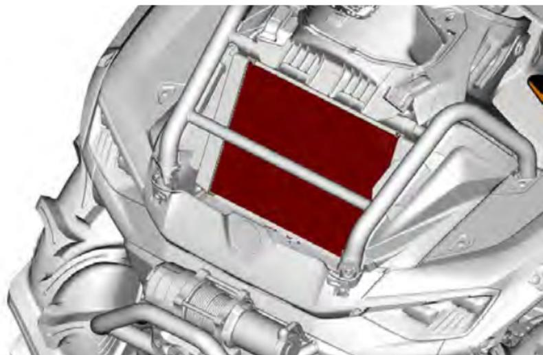
5. ラジエーターとホースに漏れや損傷がないか点検します。
