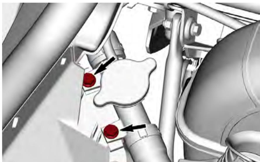
3. クーラントリザーバーをサポートに固定しているボルトを取り外します。
