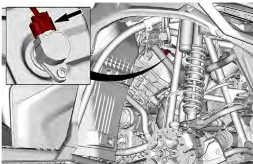
9. イグニッションコイル取り付けボルトを取り外します。
