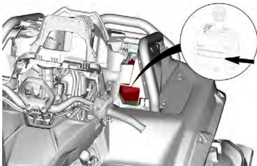
システムにクーラントを補充するには、クーラントリザーバーキャップを取り外します。
