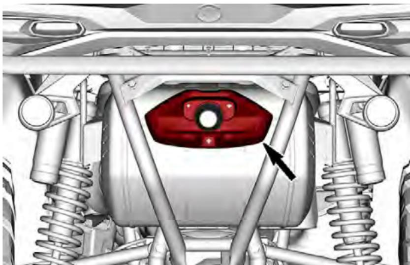
10. エキゾーストトリムを新品のねじで固定します。規定のトルクで締め付けてください。
