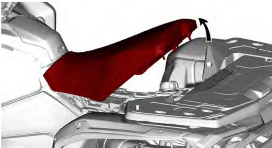
3. 座席を後方に引いて前側の固定タブを外してから、座席を完全に取り外します。
