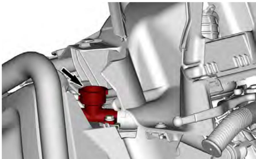
3. クーラントリザーバーのMAXの線まで充填します。
