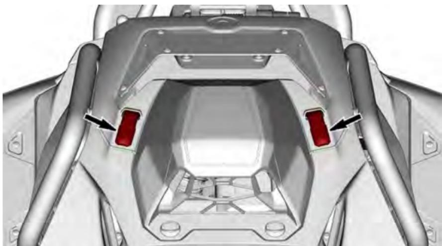
5. クォーターターンネジを時計方向に回して、シュノーケルを固定します。
