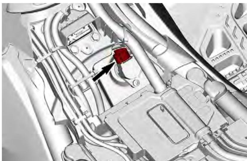
5. イグニッションコイル取り付けボルトを取り外します。
