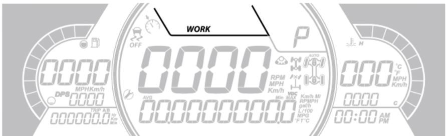
エンジンモードの表示では、選択された動作モードが示されます。
