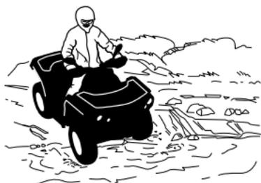
水による制動は、車両の制動能力に影響します。車両が水たまり、泥または雪から離れた後は、ブレーキを数回かけて乾燥させてください。制動距離を長めに取ってください。
