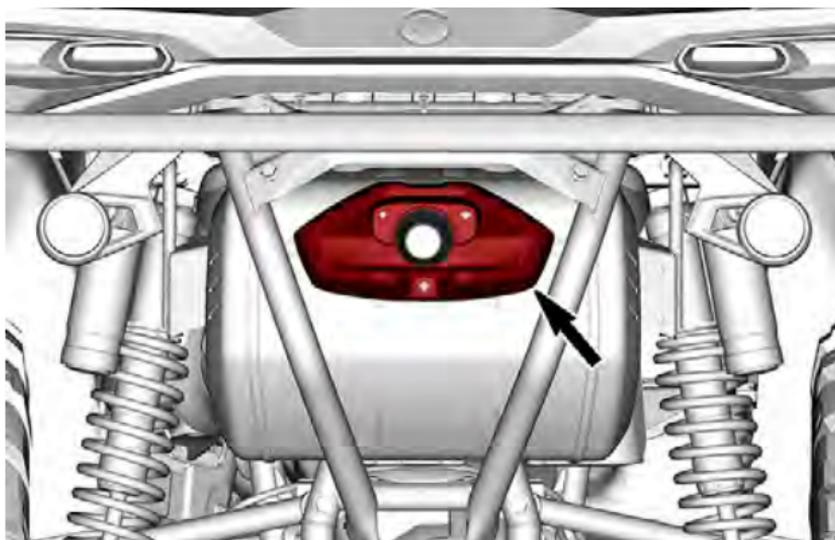
3. スパークアレスタを取り外してガスケットを破棄します。
