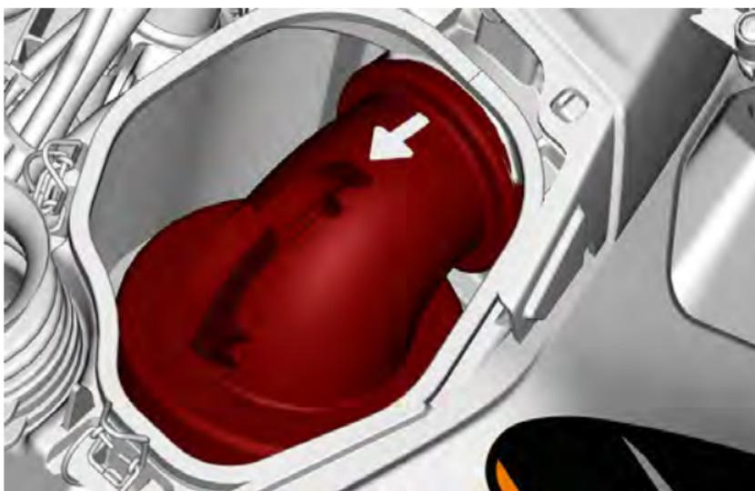
6. エアフィルターアダプターとエアフィルターをエアフィルターハウジングから慎重に引き出します。
