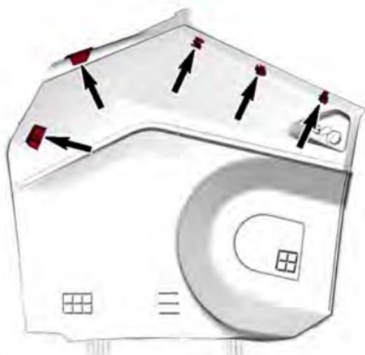
4. サイドパネルを車両外側へ傾けてから引き上げ、車両から取り外します。
