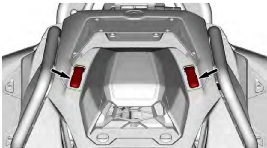
4. コンソールの両方のクォーターターンネジを外します。
