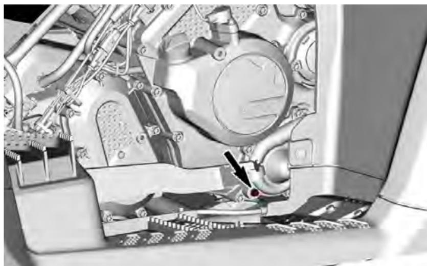
3. クーリングシステムを完全に空にするために、ウォーターポンプカバーからロアラジエーターホースを外して、残りのクーラントを適切な容器に抜き取ります。Oetikerクランプを処分します。
