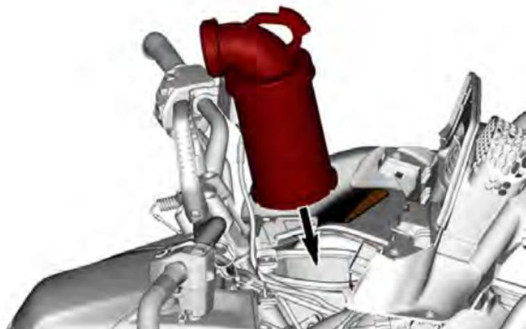
3. ハンドルを使用して、エアフィルターアダプターをエアフィルターハウジングのキャビティにしっかり押し込みます。
