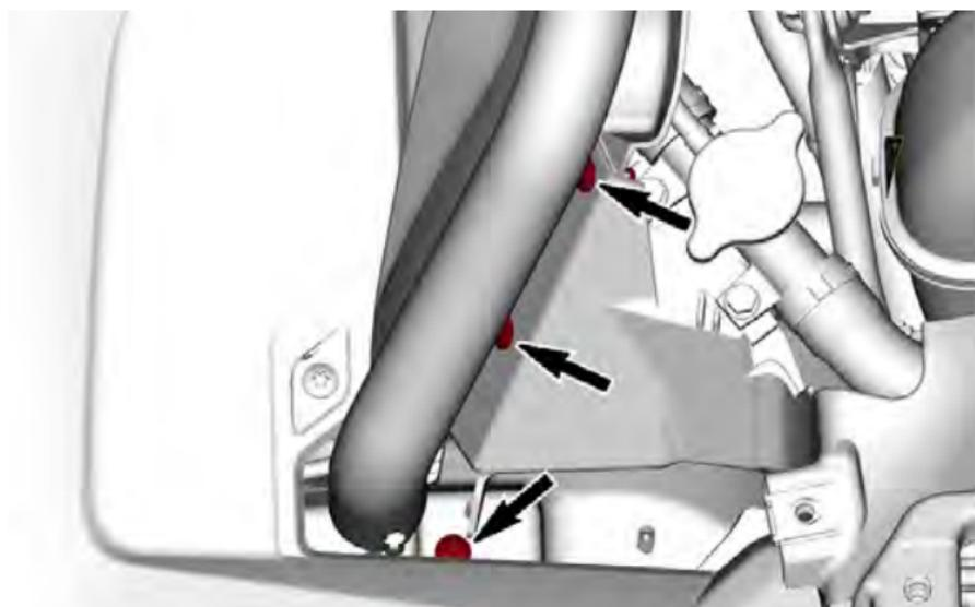
2. フィラーネックを固定している両方のボルトを取り外します。
