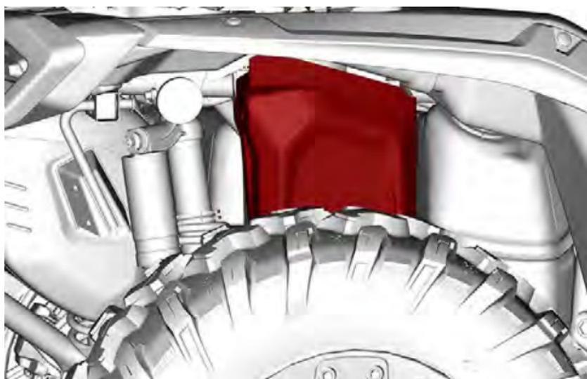
6. 前に取り外したプラスチックリベットでバッテリーカバーを固定します。
