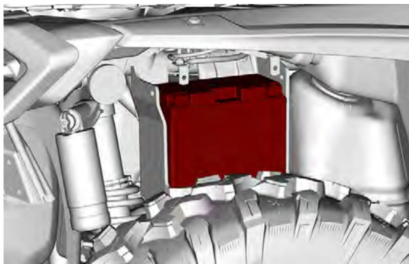
2. バッテリーをバッテリー固定ストラップで固定します。
