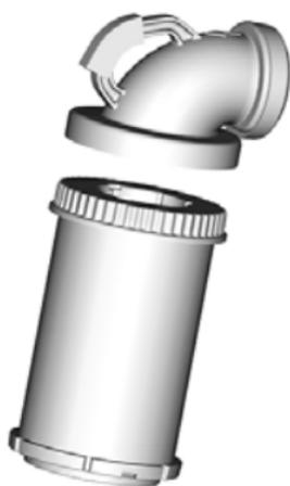
2. エアフィルターアダプターとエアフィルターをエアフィルターハウジングに差し込みます。
