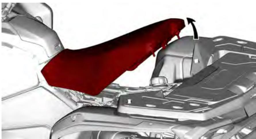
4. 座席を後方に引いて前側の固定タブを外してから、座席を完全に取り外します。
