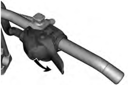
Gashebelposition für Daumenbetätigung: zum Drehen des Gashebelgehäuses nach unten drücken
