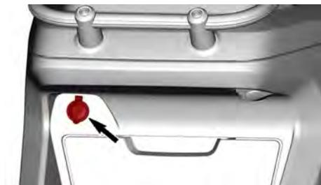
Avant et pendant l'utilisation, assurez-vous que le joint autour du port de charge USB 12 volts est intact et correctement positionné.
