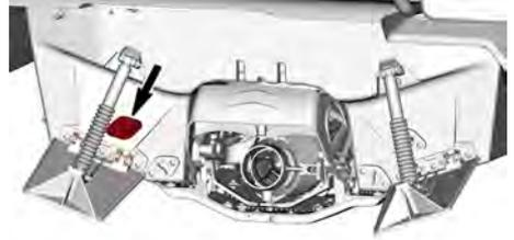
Avec un raccord de rinçage, injectez de l'air comprimé dans le système 379 kPa/55 lbf/in<sup>2</sup> jusqu'à ce qu'il n'y ait plus d'eau qui s'écoule par la turbine.
