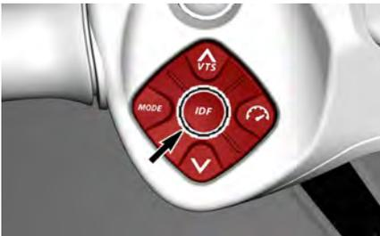
Il permet d'activer le système iDF. Reportez-vous à la section *Activation du système de pompe anti-débris intelligent (iDF)* dans la section *Instructions d'utilisation*.
