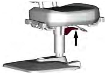
2. Pour verrouiller le siège en position, relâchez la poignée centrale et le siège se verrouille dans la position la plus proche (par incréments de 90 degrés).
