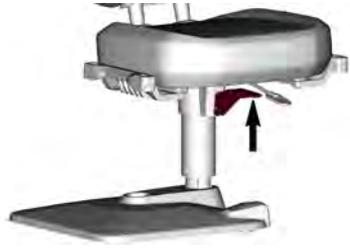
Lorsque vous réinstallez le siège sur le mât, assurez-vous que la poignée peut bloquer le mouvement de pivotement du siège.
