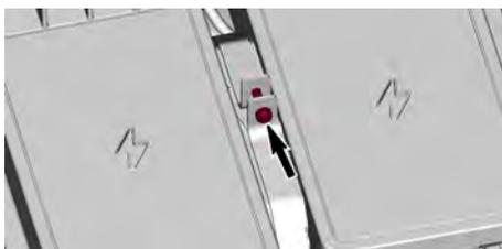
4. Mettez les sangles de côté et retirez le capot de la batterie.
