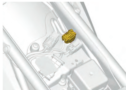
Ubicación del conector del OBD
