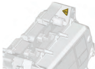
Batería de alto voltaje
