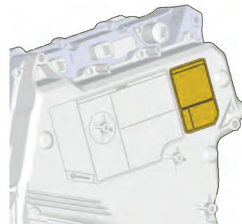
Batería de alto voltaje
