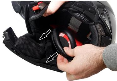
**A.8.** Verbinden Sie das Lautsprecherkabel wieder mit der SCHWARZEN Buchse der Haupteinheit. Wiederholen Sie den Vorgang auf der anderen Seite.
