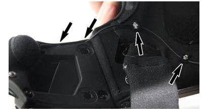
**5.** Stellen Sie sicher, dass der ROTE Steckverbinder korrekt angeschlossen ist und der Pfeil auf das Sena-Logo zeigt.
