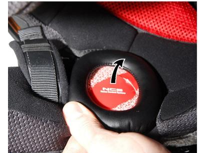
A.2. Entfernen Sie die Schaumstoffeinlage aus jeder Geräuschkämpfung. Reißen Sie hierzu das runde Teil heraus.
