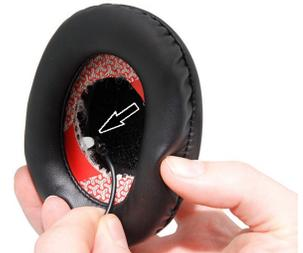
A.5. Führen Sie den Lautsprecheranschluss so durch das Loch hinten an der Geräuschkämpfung, dass er hinten zum Helm zeigt.
