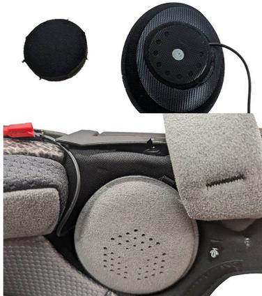
**C.4.** Setzen Sie die Ohrpolster wieder im Helm ein und achten Sie darauf, dass das Kabel hinten zum Helm zeigt.
