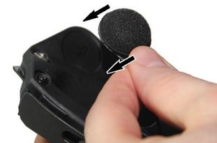
**14.** Positionnez le microphone sur le Velcro installé à l'étape précédente sur le côté intérieur droit du casque, positionnez les différents fils pour les garder hors de portée.
