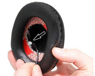
A.5. Faites passer la connexion du haut-parleur dans le trou situé à l'arrière du SSB de manière à ce qu'elle soit orientée vers l'arrière du casque.
