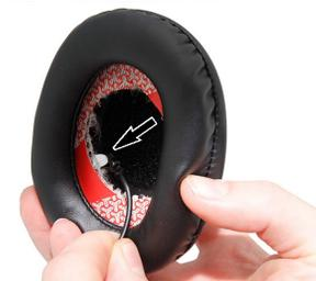
A.5. Far passare il collegamento dell'altoparlante nel foro sul retro del NCS in modo che sia rivolto verso la parte posteriore del casco.
