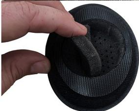
**C.3.** Installare l'altoparlante nel cuscinetto auricolare dalla parte posteriore.
